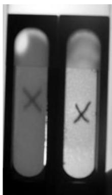
**Figure II.21.** Image d'une miniémulsion de monomères avec un diamètre de gouttelette moyen de 40 nm (à gauche). La croix noire dessinée à l'arrière de la cellule d'épaisseur 1 mm est d'abord peu visible en raison de la forte atténuation de la lumière. Après une exposition aux UV de 3 min, la même miniémulsion (à droite) est beaucoup moins diffuse, ce qui permet ainsi une observation plus précise de la croix.
