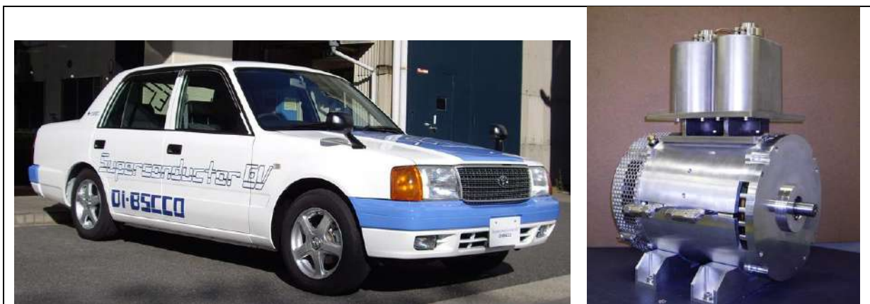
Figure I.55. Présentation de la voiture électrique de Sumitomo Electric avec son moteur supraconducteur Lien
