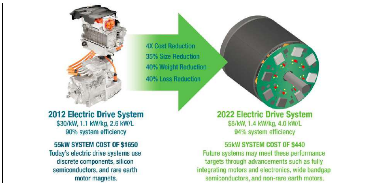
Figure I.25. Évolution du coût, poids, volume, puissance et rendement du groupe moteur propulseur
