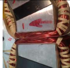
Figure IV.64. Bobinage d'un plot statorique de la MDCF
