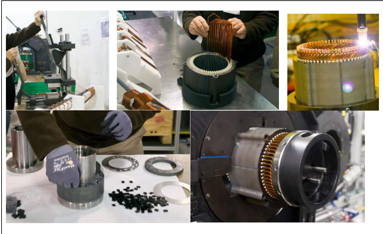
Figure I.54. Construction et assemblage du moteur électrique de la Chevy Spark de GM Lien
