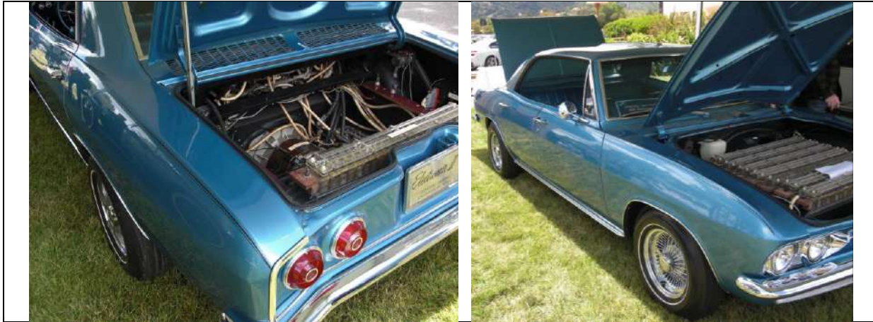
Figure I.6. Electrovair II (1966) de General Motors alimentée par batteries de zinc de 532 volts
