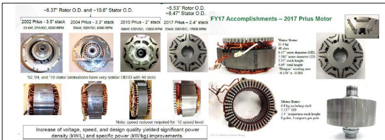
Figure I.52. Evolution de la motorisation de la Prius entre 2002 et 2017
