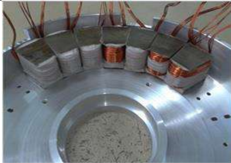
Figure IV.61. Vue de face du stator de la MSAPFA en cours d'assemblage
