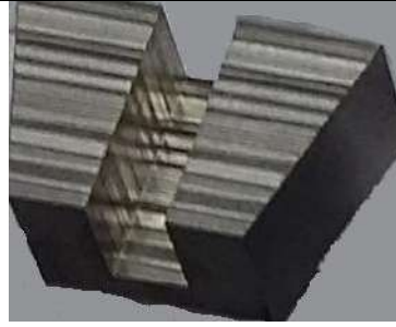
Figure IV.60. Plot élémentaire du circuit magnétique statorique de la MDCF
