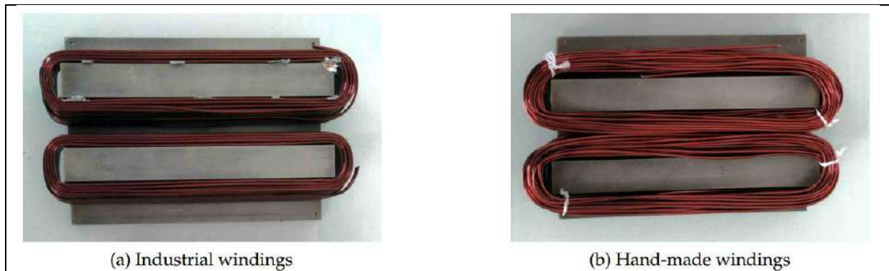
Figure II.8. Processus de bobinage dentaire
