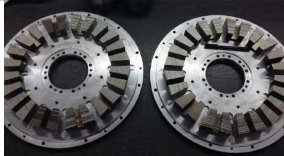
**Figure IV.62. Vue de face de chaque stator de MDCF sans les aimants permanents**
