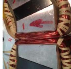
**Figure IV.64. Bobinage d'un plot statorique de la MDCF**
