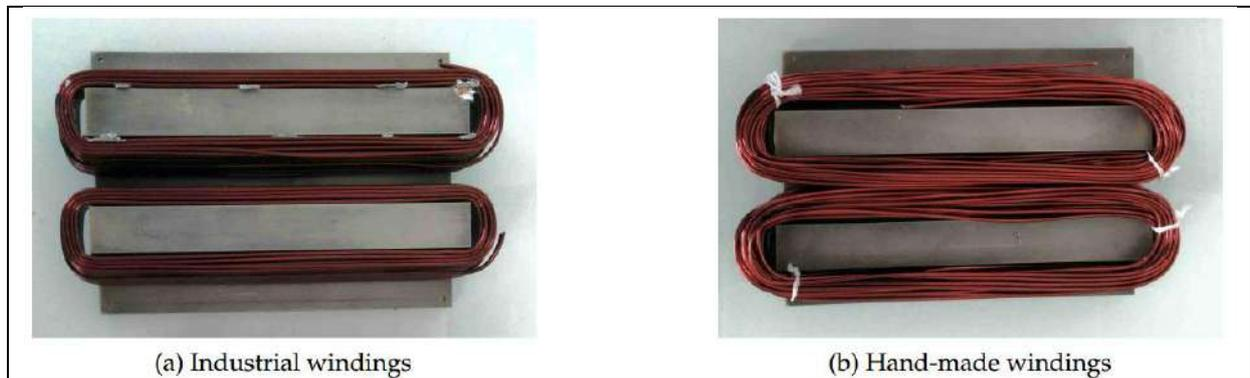
Figure II.8. Processus de bobinage dentaire
