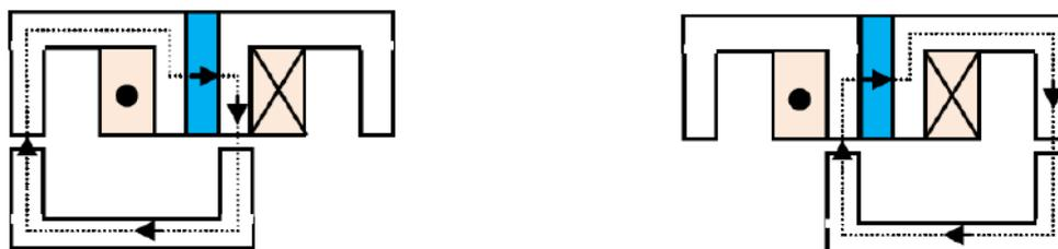
(a) Flux de l'aimant traversant de bas en haut la bobine
