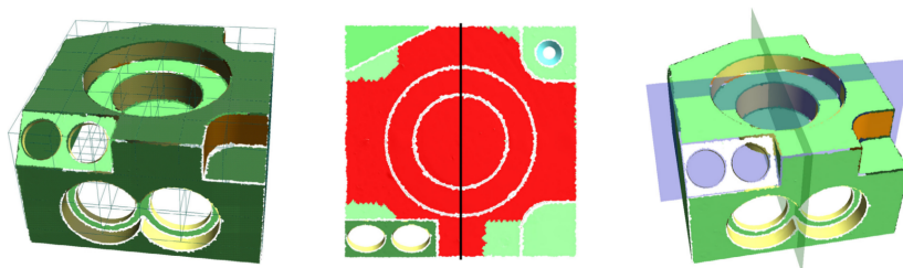
FIGURE 2.29 – Embellissement de Kovács et al. [54] à partir d'une grille 3D et de symétries partielles.
