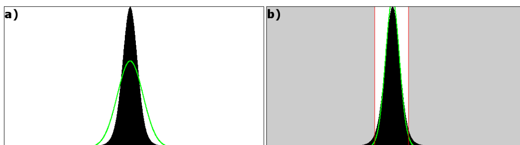
FIGURE 3.29 – Estimation des paramètres d'une Gaussienne pour un sous-maillage numérisé : a) A partir de toutes les valeurs de courbure, b) A partir de l'intervalle de courbure correspondant au mode.
