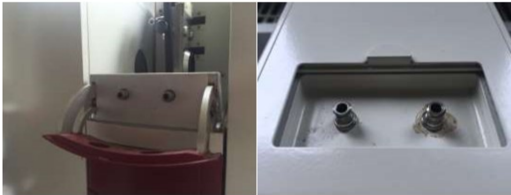
Photo 2 : Présentation des embouts luer-lock situés au niveau du système d'analyse particulaire Qicpic®
