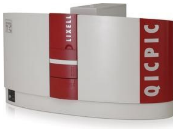
Photo 1 : Système d'analyse particulaire Qicpic®.
