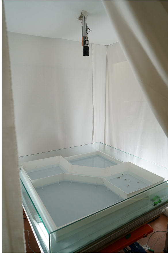
FIGURE 3.3 – Système expérimental avec l'aquarium surélevé, le drap isolant et la caméra qui surplombe.
