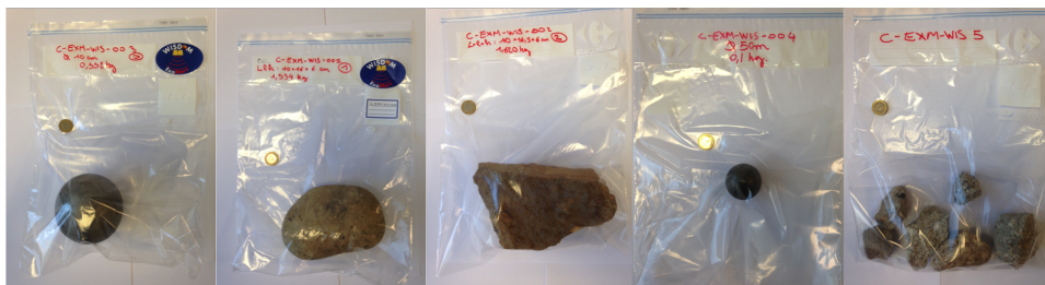
FIGURE 5.31 – Cibles (de gauche à droite) : sphère métallique de 10 cm de diamètre, galet (roche lisse), roche anguleuse, sphère métallique de 5 cm de diamètre et ensemble de petites (<5 cm) roches.
