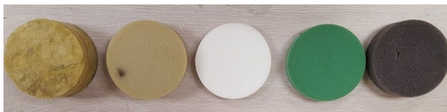
Figure 2.1 – Échantillons de divers matériaux poreux utilisés dans l'ingénierie pour le contrôle du bruit
