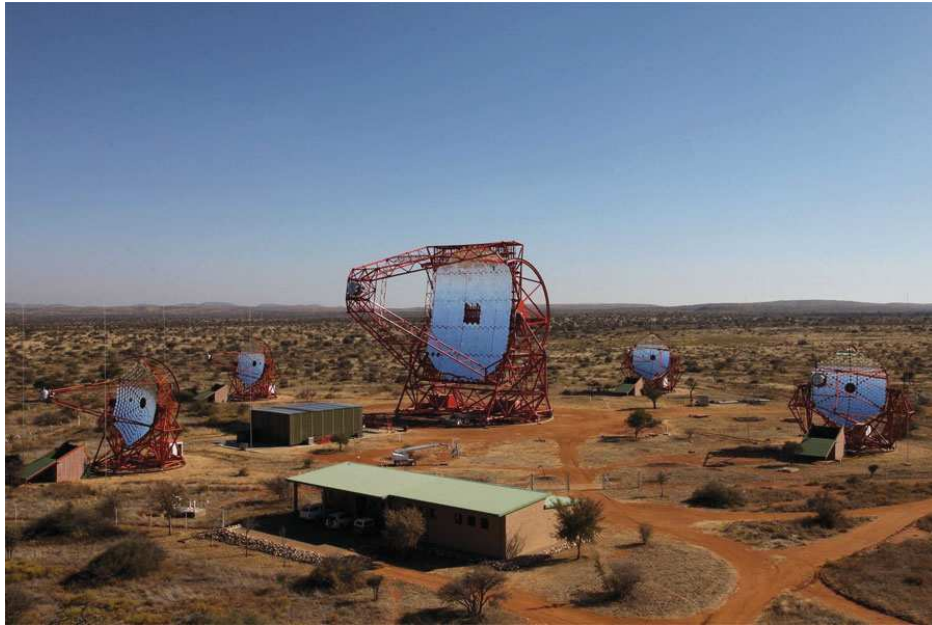
FIGURE 4.1 – Réseau de télescopes H.E.S.S. en Namibie, dans la région du Khomas. Les abris pour protéger les caméras sont situés en face de chaque télescope et la salle de contrôle apparaît au premier plan.
