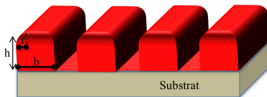
Figure I. 23 : Modélisation paramétrique d'un profil rectangulaire arrondi au sommet défini par le rayon de courbure r , la longueur du plateau b et sa hauteur h
