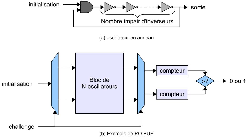
FIGURE 1.18 – Schéma d’une RO-PUF.
