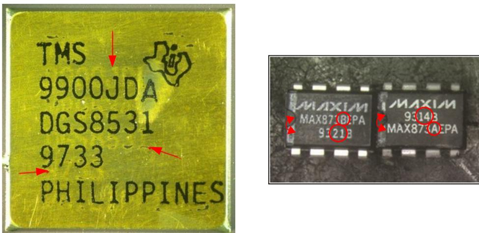
FIGURE 1.4 – Exemples de circuits intégrés re-marqués.
