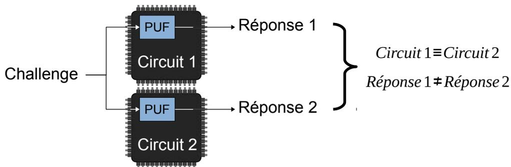
FIGURE 1.15 – Le concept d'une fonction physique non-clonable.
