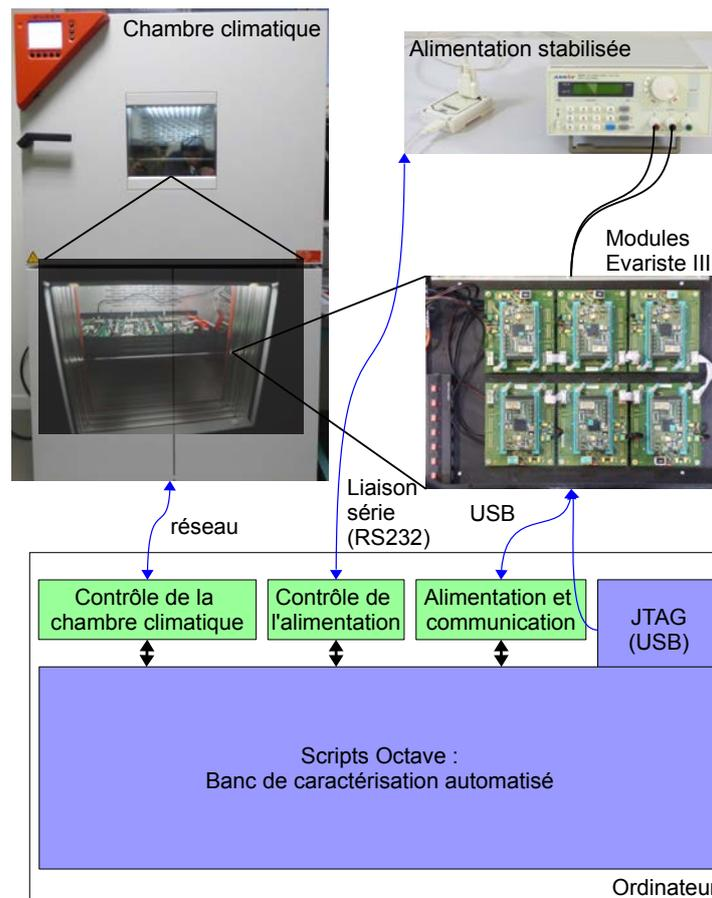
FIGURE 3.11 – Le banc de caractérisation complet de PUF.
