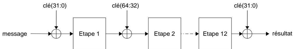
FIGURE 5.4 – Schéma du chiffrement d'un message avec l'algorithme LED.
