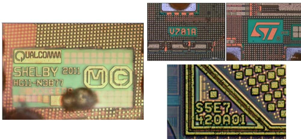
FIGURE 1.12 – Marquage sur puce et détection de contrefaçon.
