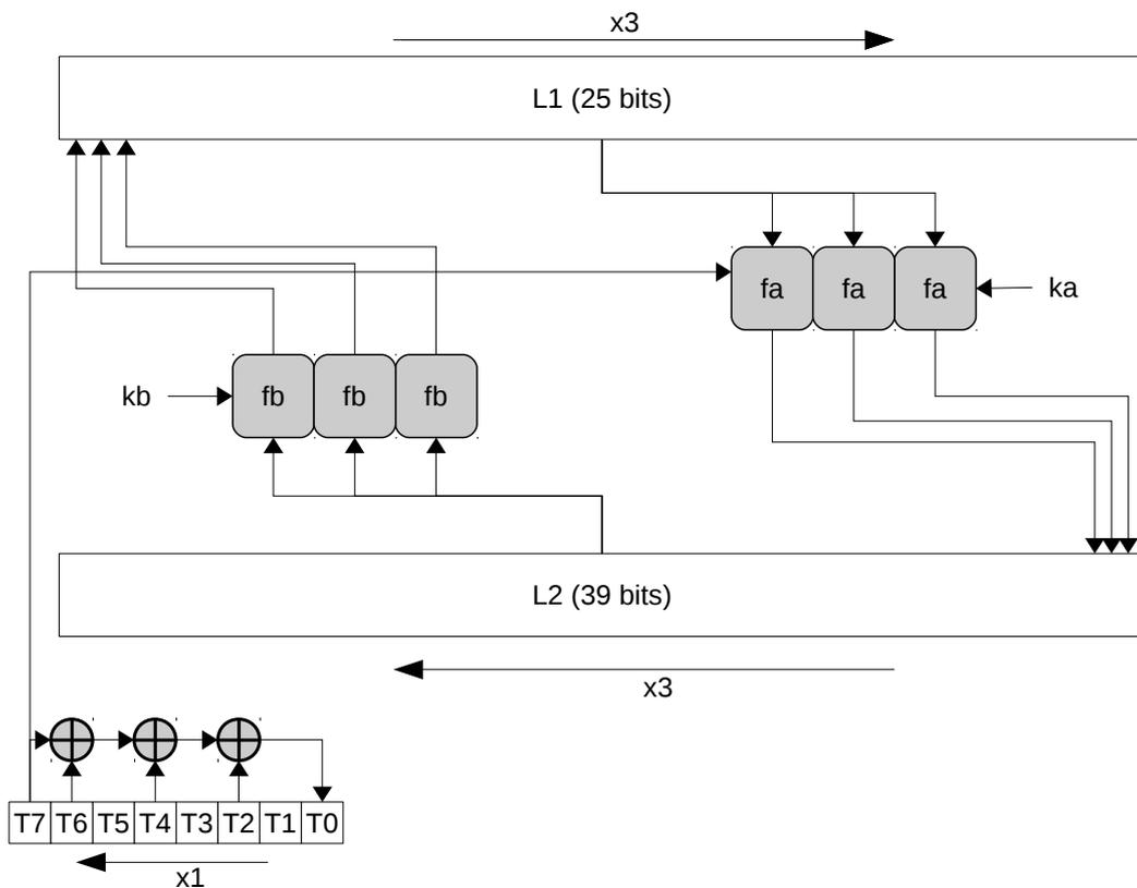
FIGURE 5.10 – Implantation matérielle parallèle de KTANTAN.
