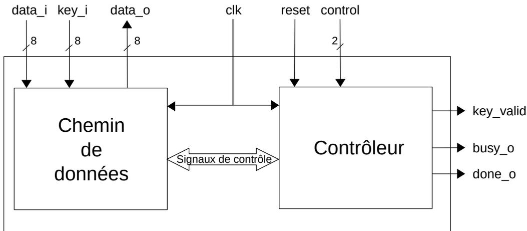
FIGURE 5.11 – Schéma de la plateforme commune utilisée pour l'implantation des algorithmes de chiffrement.
