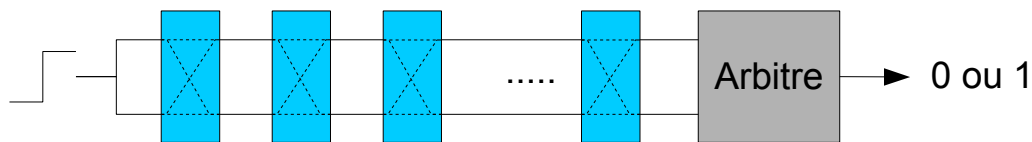
FIGURE 1.17 – Schéma d'une arbiter-PUF .
