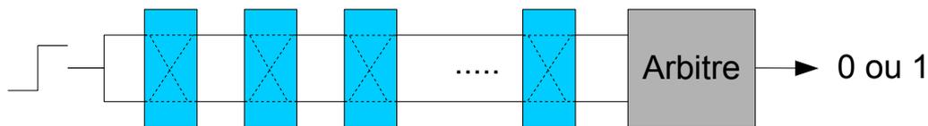
FIGURE 1.17 – Schéma d'une *arbiter-PUF*.
