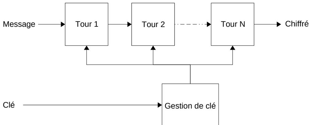
FIGURE 1.22 – Schéma générique d'un chiffrement par bloc.
