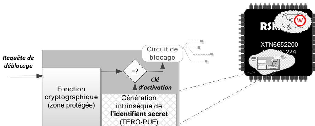
FIGURE 2.1 – Positionnement du *watermarking* dans le projet SALWARE.
