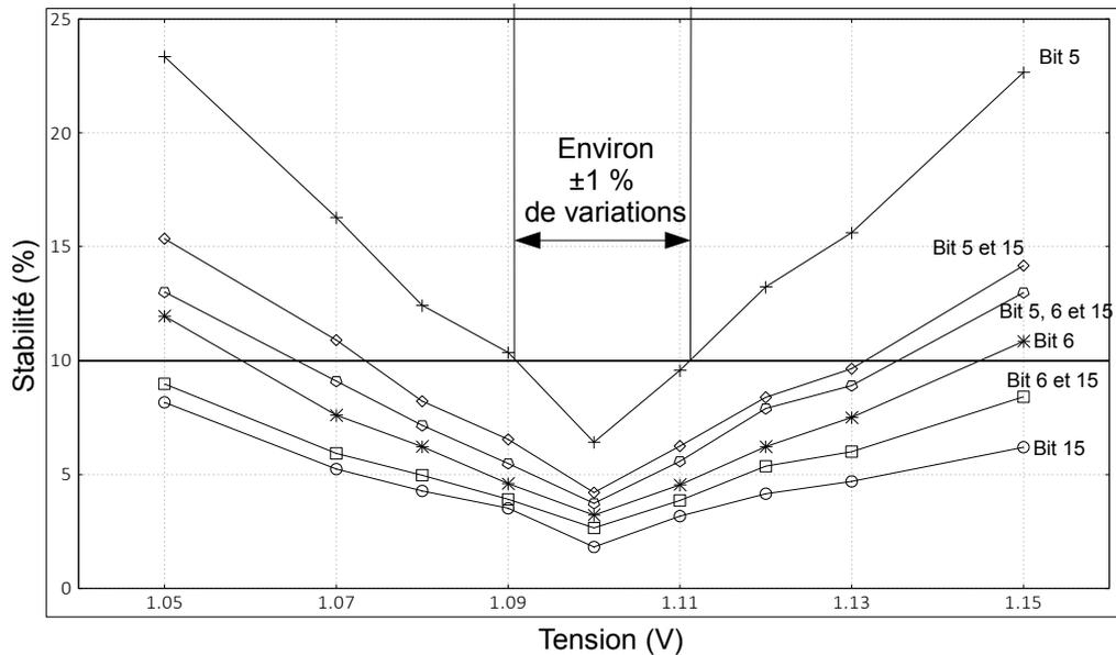
FIGURE 3.17 – Étude de la stabilité moyenne des identifiants de 128 bits générés grâce aux réponses de la TERO-PUF en fonction des bits de sortie sélectionnés et vis-à-vis des variations de tension, pour une durée d’acquisition de 30 cycles d’horloge à 50 MHz sur 16 FPGA Altera Cyclone V.
