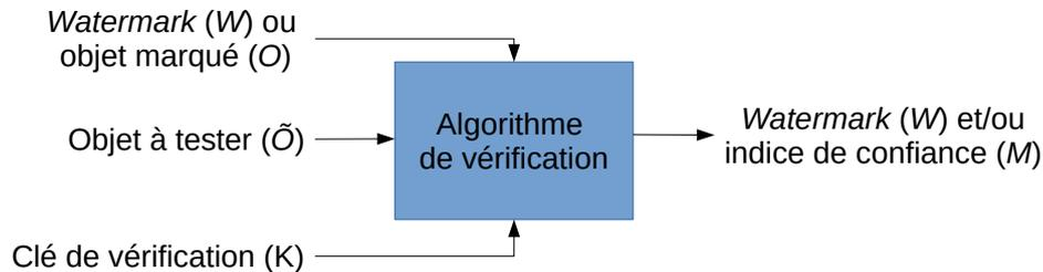
FIGURE 2.5 – Concept général de la vérification d'une *watermark*.
