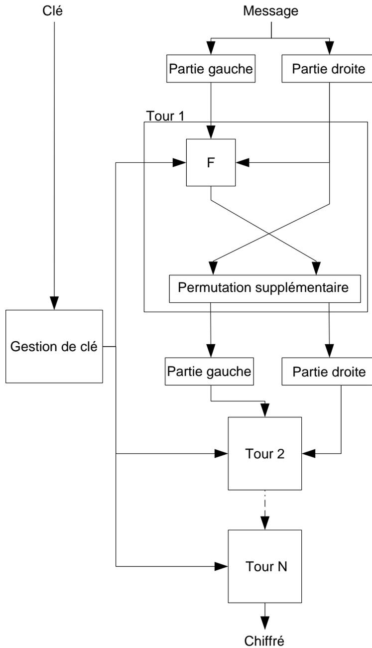
FIGURE 1.23 – Schéma générique d'un réseau de Feistel.
