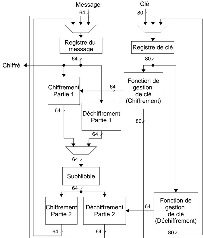
FIGURE 5.2 – Schéma de l'implantation parallèle de l'algorithme KLEIN.
