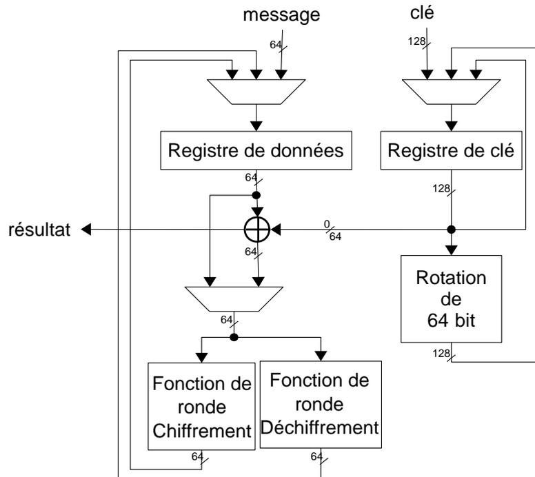
FIGURE 5.7 – Implantation matérielle parallèle de LED.
