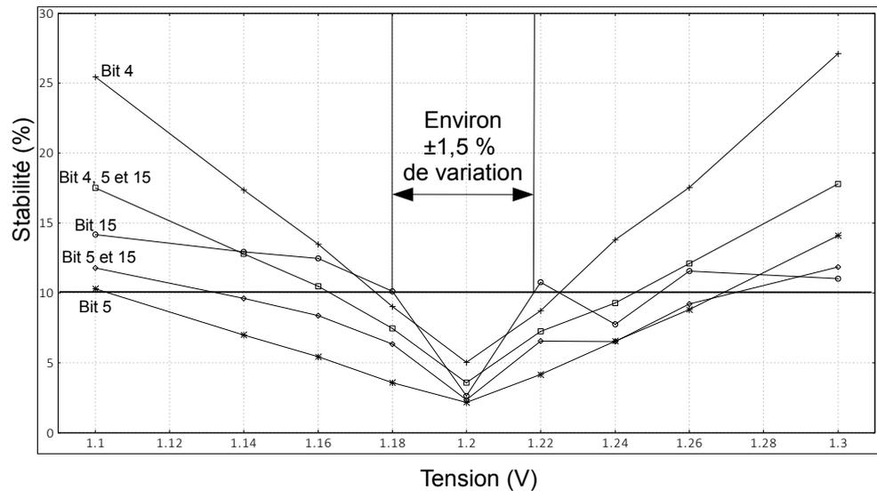
FIGURE 3.14 – Étude de la stabilité moyenne des identifiants de 128 bits générés grâce aux réponses de la TERO-PUF en fonction des bits de sortie sélectionnés et vis-à-vis des variations de tension, pour une durée d’acquisition de 30 cycles d’horloge à 50 MHz sur 30 FPGA Xilinx Spartan 6.
