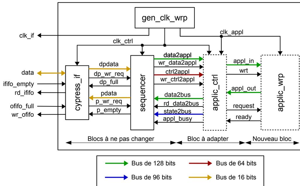
FIGURE 2.11 – Schéma bloc interne du FPGA pour le système Evariste II.
