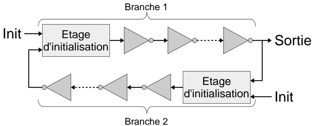
FIGURE 3.2 – Schéma d'une cellule TERO.
