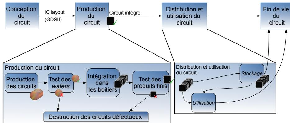
FIGURE 1.1 – Cycle de vie simplifié d'un circuit intégré.
