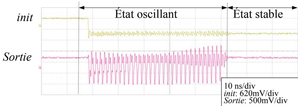
FIGURE 3.3 – Comportement de la sortie d’une cellule TERO.
