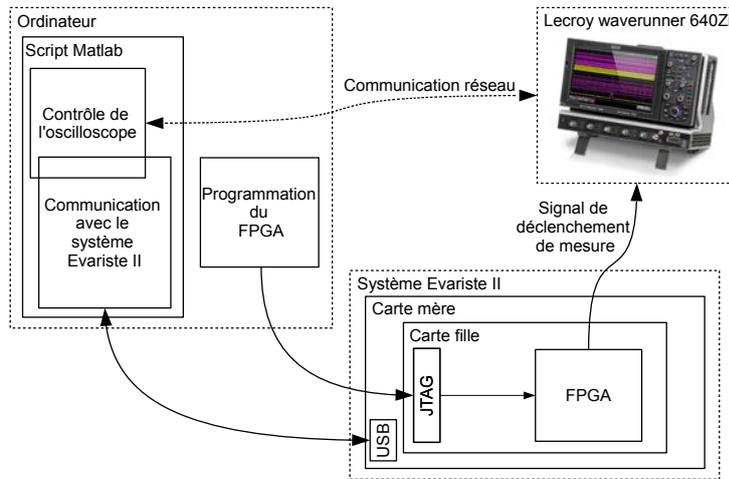
FIGURE 2.9 – Représentation schématique du banc de mesure complet.
