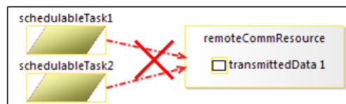
FIGURE 5.11 – Invariant pour éviter les doubles connexions
