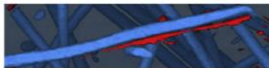
Figure I.2.3 : Décohésion fibre-matrice [Rolland et al., 2016]
