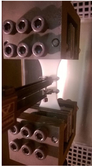
Figure II.3.2 : Photographie du montage pour les essais à R = 0, 1
