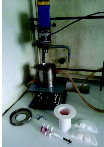
Figure 2-9 : Dispositif d'attrition utilisé pour nos synthèses.
