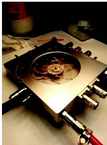
Figure 3-14 : Support en platine où est fixé l'échantillon.
