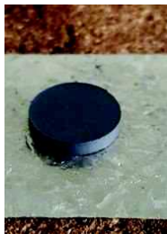
Figure 2-14 : Pastille de CoFe_2O_4 obtenue après frittage.
