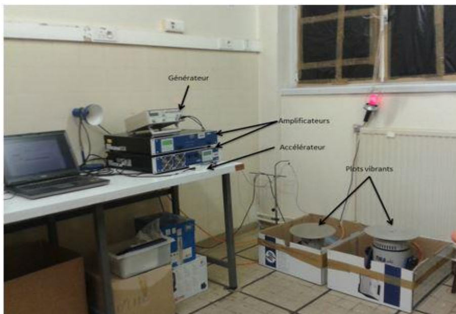
Figure 44 : Photographie de l'installation du système de vibration corps entiers. Diamètre plateau des pots vibrants 30cm.
