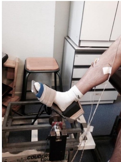
Figure 3. Positionnement du sujet lors des mesures de couple de force maximal des fléchisseurs dorsaux de la cheville (études #1 et #2). L'avant pied était fixé à la pédale instrumentalisée par une bande velcro, et des cales en bois étaient ajoutées ou retirées afin d'ajuster la hauteur du pied à la longueur de la pédale.
