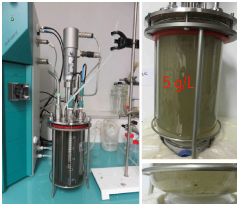
Figure III-7: Bioréacteur pendant une expérience de resuspension.
