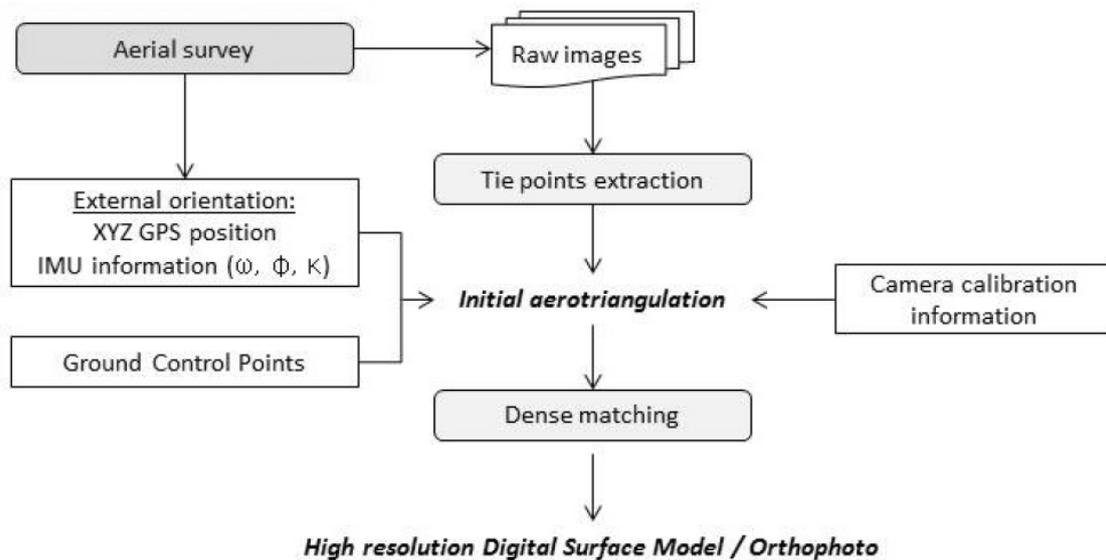
Figure 4-8 : description du processus de photogrammétrie pour passer d'une série d'images drone à une orthomosaique et un modèle numérique de surface. (Michez, 2016).
