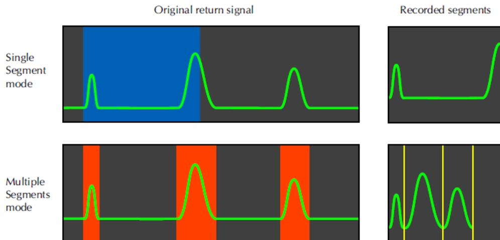
Figure 4-14 : « Single segment » et « multiple segment » modes (Optech 2014). A gauche le signal complet et à droite le signal enregistré par le capteur.
