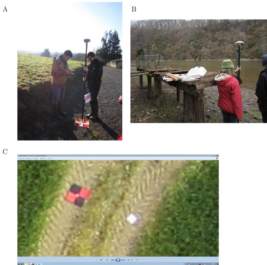
*Figure 4-9: A. Prise d'un point DGPS sur une mire. B. prise d'un point DGPS sur un objet fixe. C. Représentation de deux types de mires utilisées sur une image prise par drone : à gauche la dernière version retenue. ; à droite une première version composée d'un carré blanc de 20/20cm.*
