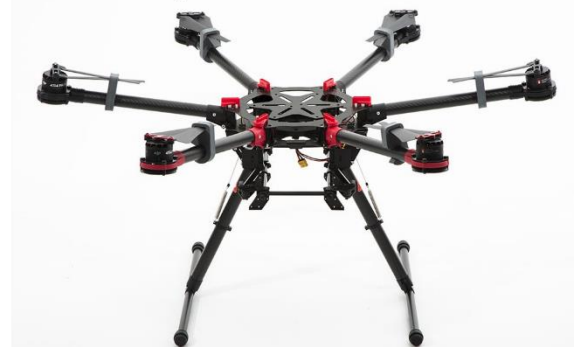
Figure 4-6 : Les deux types de drones : A. Aile volante (e-bee de sensefly dernière génération), B. hexacoptère (drone S900 dernière génération).
