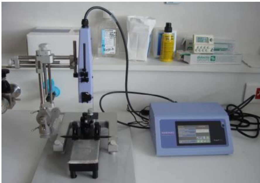
Figure 18: Illustration du dispositif d'injection intracérébrale par Convection-Enhanced Delivery pour les modèles murins disposés sur le cadre de stéréotaxie (Pump 11 elite 70-4507INT, Harvard Apparatus®, Les Ulis, France).
