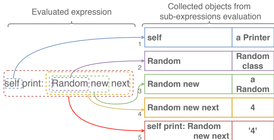
FIGURE 5.4 – Collection en profondeur. Le point de collecte est l’expression globale. Le collecteur s’installe sur chaque sous-expression du point de collecte (à gauche), et les objets issus de leur évaluation sont collectés (à droite).
