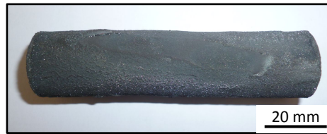
FIGURE 1.10 – Géométrie d'un barreau après un dressage à 93 mm suivi d'un pré-écrouissage de 12 % et d'une recristallisation à 850 °C pendant 150 heures, la croûte d'oxyde ayant été retirée
