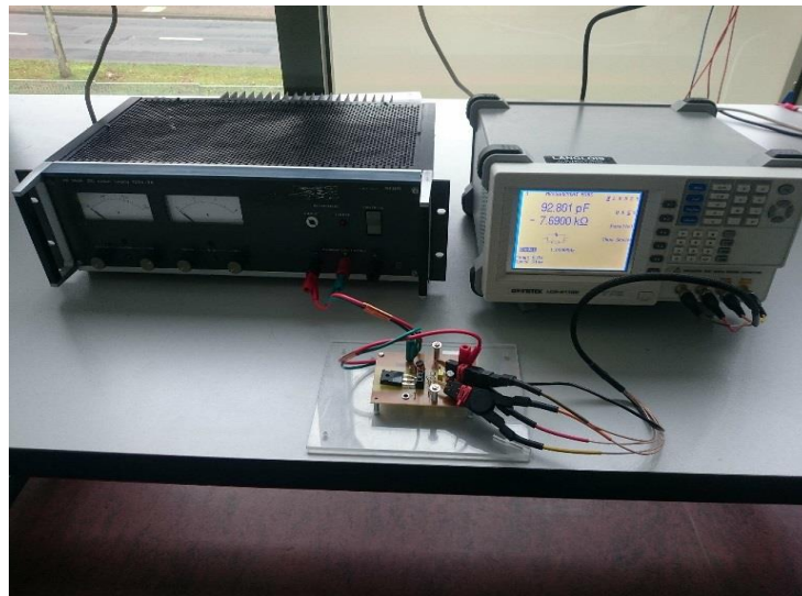
Figure 2.28 Photo du banc de mesure des capacités intrinsèques et extrinsèques de MOSFET SiC
