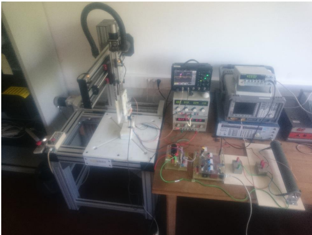
Figure 4.3 Photo du banc expérimental de mesure des PEM rayonnées avant et après les tests de vieillissement en régime de court-circuit et HTGB
