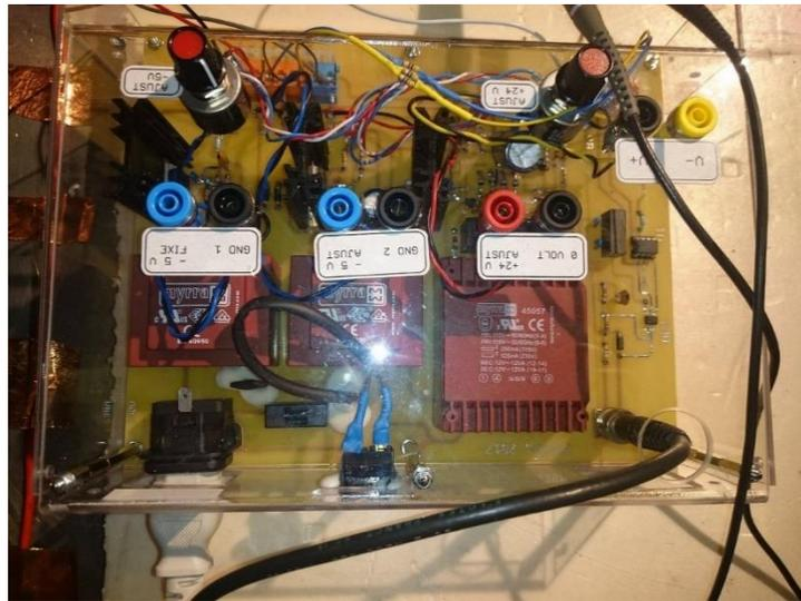
Figure 3.1 Circuit de commande pour le transistor SIC\_MOSFET\_1
