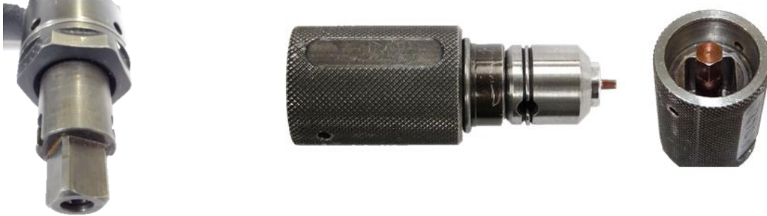
Figure A3.0-7 Interface côté visseuse (à gauche) et ensemble porte douille-douille (à droite)
