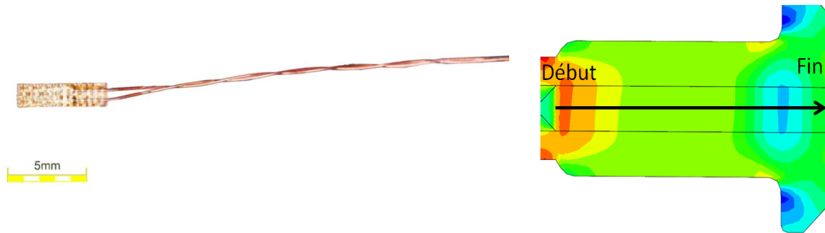
Figure 4.2-2 Jauge de déformation pour la mesure de la pré-tension et Chemin servant à la mesure de déformation
