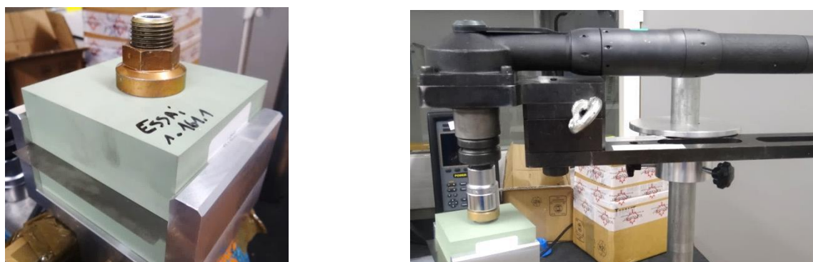
Figure 3.3-1 Eprouvette serrée (à gauche) et moyen de serrage (à droite)
