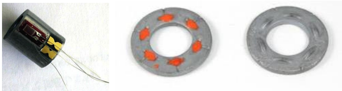
Figure 1.3-10 Rondelle instrumentée tirée de [CHA12] (à gauche) et Rondelle type DTI (à droite)
