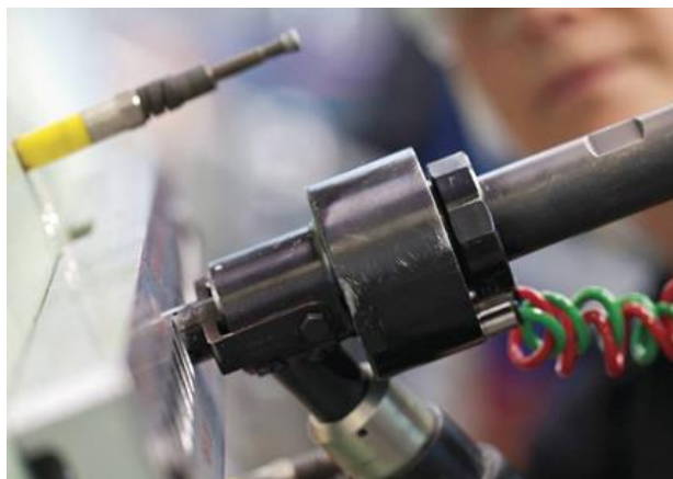
Figure 1.1-3 Machine de perçage semi-automatique posée sur une grille de perçage
