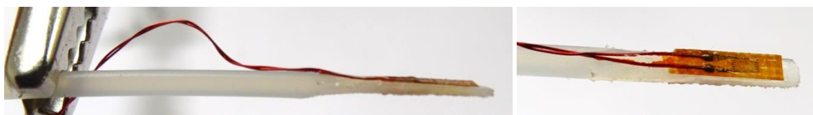
Figure A2.0-4 Jauge montée sur son support vue de profil (à gauche) et vue de dessus (à droite)
