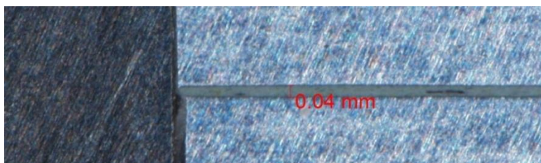
Figure 3.2-25 Mesure de l'épaisseur de peinture à l'interface
