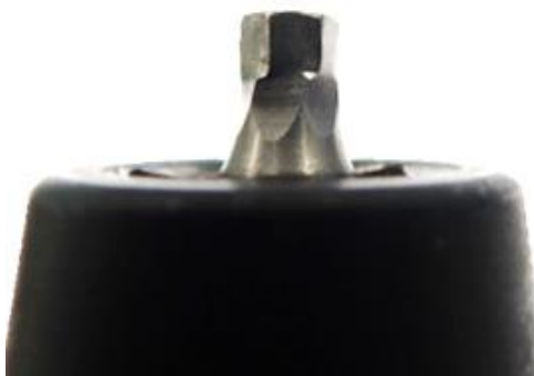
Figure 3.4-3 Immobilisateur endommagé à la suite d'un serrage dans les filets imparfaits
