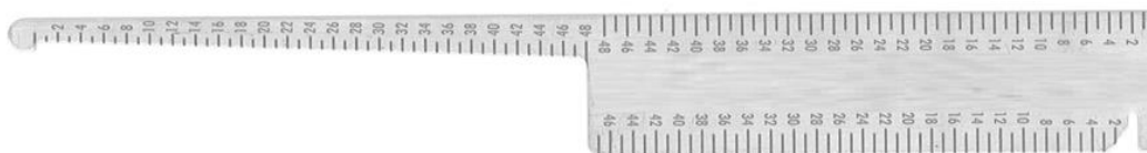
Figure 3.4-4 Jauge utilisée pour la sélection de vis
