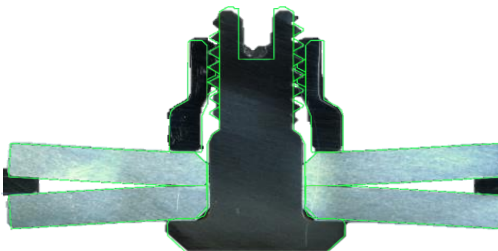
Figure 3.2-17 Comparaison entre une éprouvette découpée et la simulation vis courte, jeu de 1 mm
