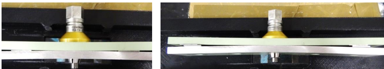
Figure 3.6-2 Essai avec cales en position proche (à gauche) et essai avec cales en positions éloignées (à droite)
