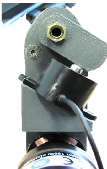
Figure 4.1-2 Prototype de mesure de couple de réaction avec un capteur de force
