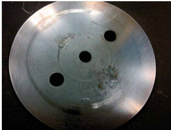
Figure 2.26. Phénomène de matage de la masse inertielle
