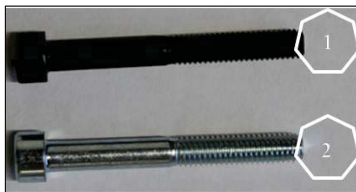
Figure 2.16. Vis testées : (1) vis traitée, (2) vis zinguée
