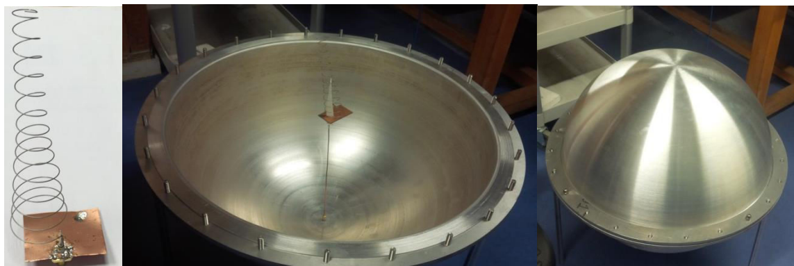
Figure IV-22 : Antenne hélice : Prototype et mesure S11
