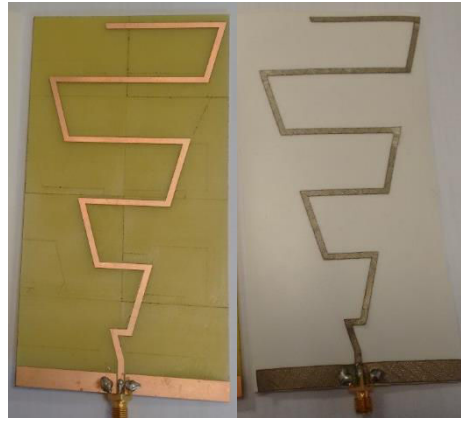
Figure II-33 : Prototype du monopole à méandres bow-tie imprimé sur FR4 et Silicone
