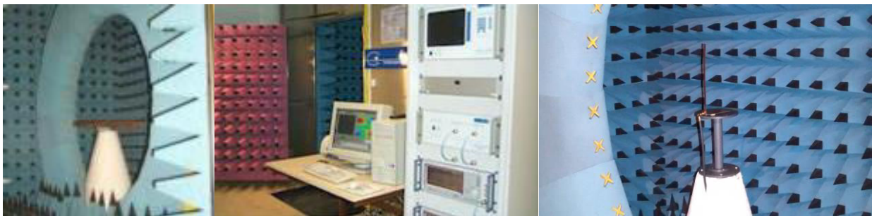
Figure III-31: Satimo SC32 : mesure du gain réalisé
