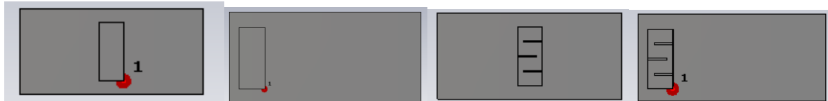
Figure II-46 : Configurations simulées pour l'antenne PIFA – patch centré/décentré pour n=0/n=3
