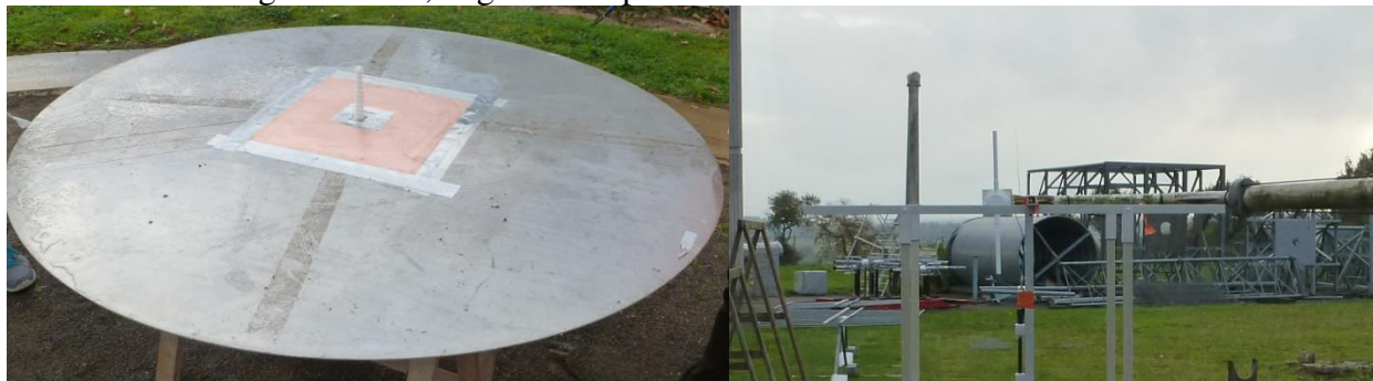
Figure IV-23 : Mesure du gain de l'antenne hélice à TDF
