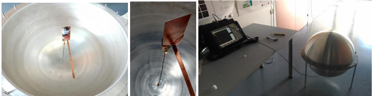
Figure III-50: Mesure en Wheeler Cap - batterie au-dessus du plan de masse
