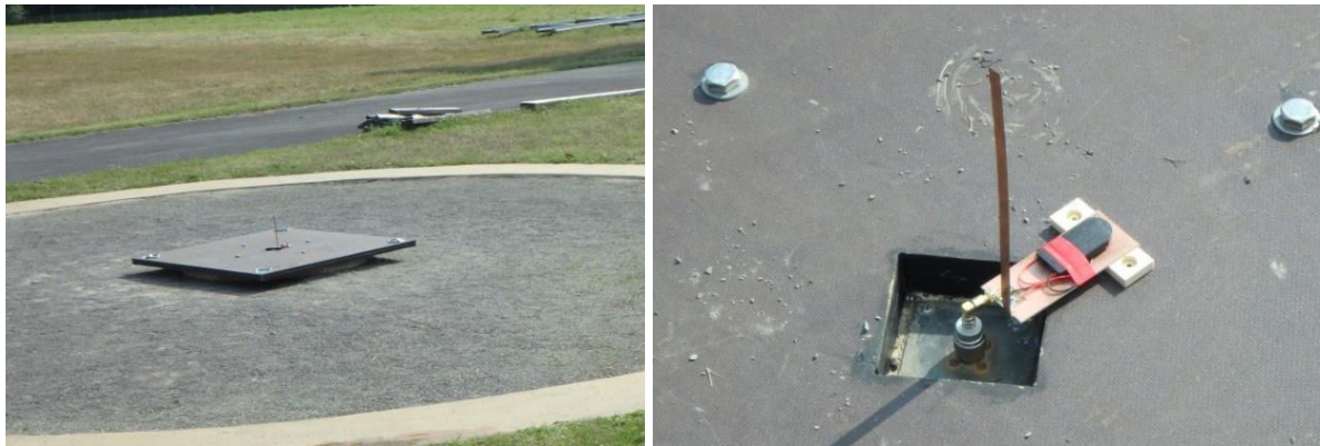
Figure III-63 : Schéma représentatif du plateau (en bois) supportant l'antenne.
