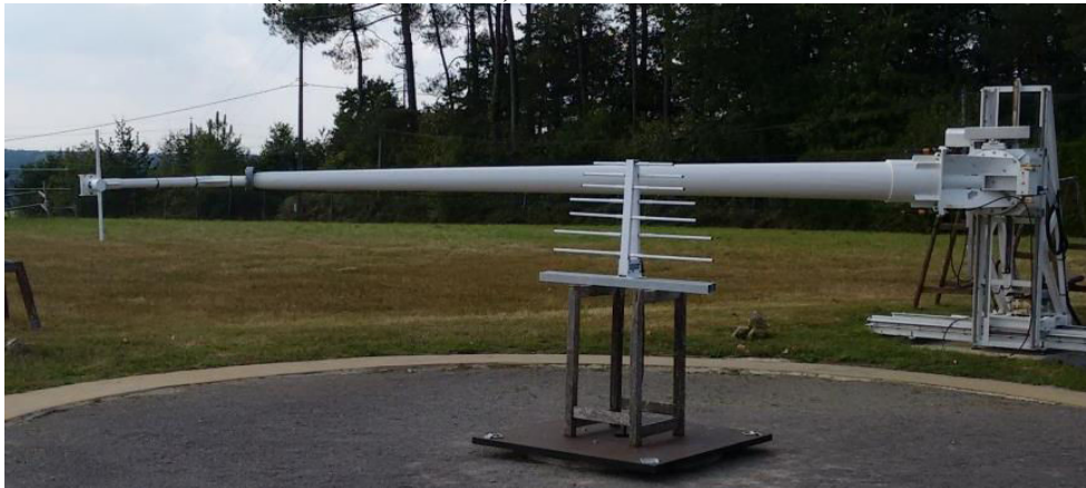
Figure III-59 : Antenne étalon au centre (arche visible à l'arrière)
