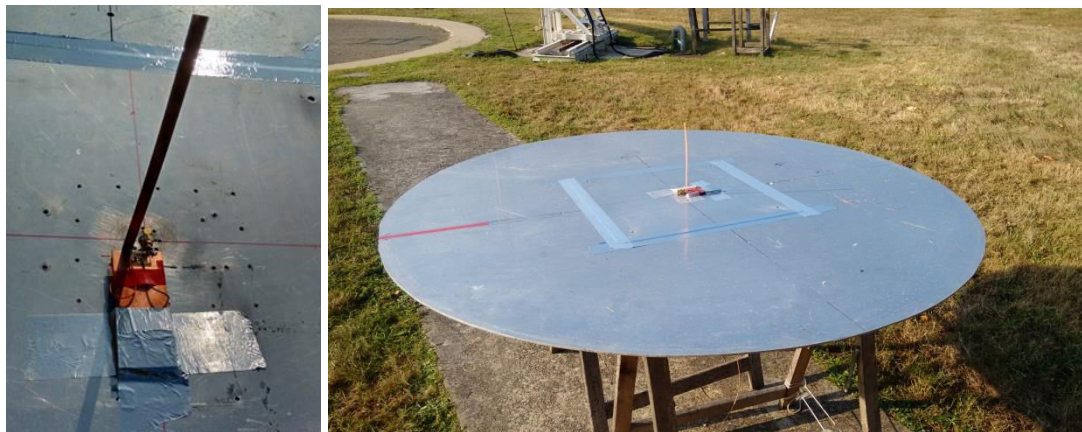
Figure III-55 : Antenne avec plan de masse relié au disque métallique (diamètre 150 cm).
