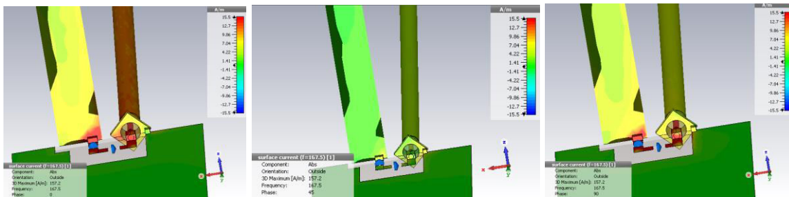
Figure III-41 : Monopole avec LC : distribution du courant
