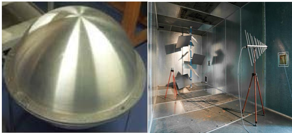
Figure III-33: Wheeler Cap et Chambre réverbérante à brassage de modes
