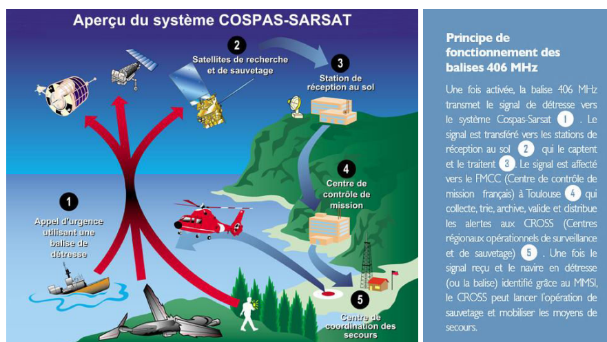
Figure 4 : Fonctionnement du système COSPAS-SARSAT
