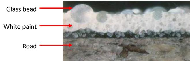
FIGURE 2.5 – Coupe d'un marquage rétro-réfléchissant à base de peinture blanche à l'eau posé (FÉRÉ 2016)
