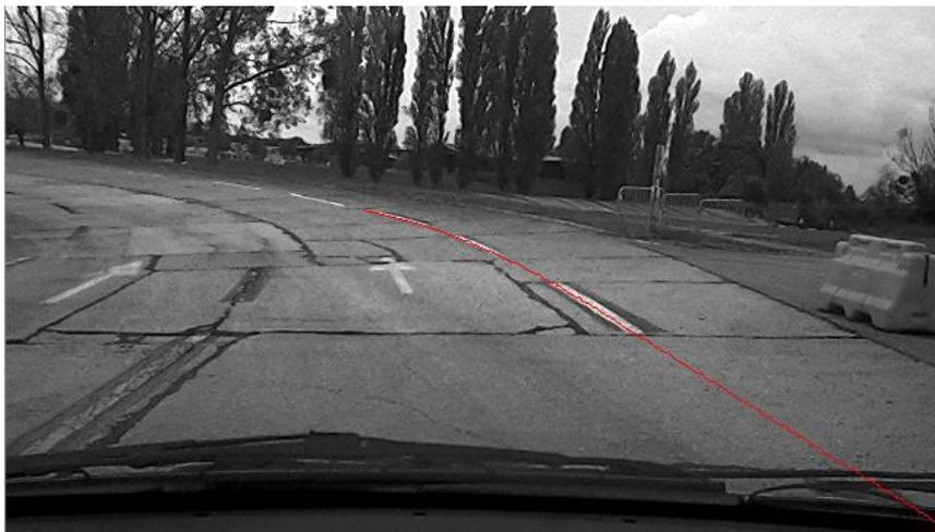
FIGURE 2.14 – Exemple d'une détection perturbée due à une infrastructure fortement dégradée (REVILLOUD et al. 2016b)
