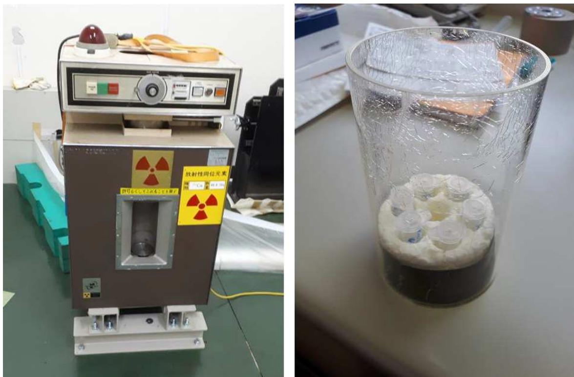
**Figure 2-23 :** Irradiateur gamma et porte-échantillons, Chiba NIRS.
