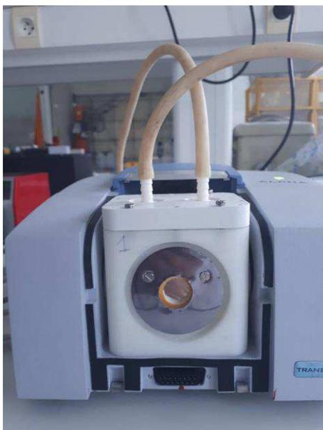
**Figure 2-21** : Cellule d'irradiation des gels comportant les tuyaux de circulation de gaz
