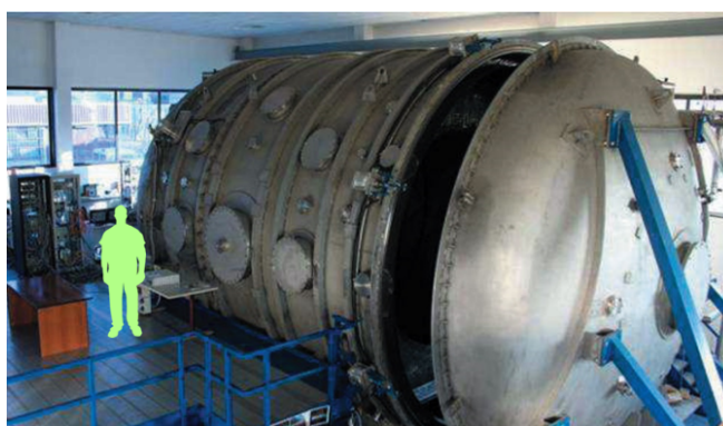
FIGURE 1.9. – Enceinte IV-10 de l’entreprise Sitael (Pise, Italie) consacrée au essais de propulseurs plasma [6]
