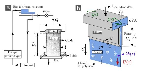
Figure 7.2 – Schéma de la boucle hydraulique (a) et de la filière (b).
