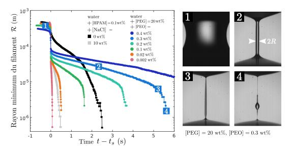
Figure 7.5 – Gauche: Rayon minimum  $\mathcal{R}$  du filament en fonction du temps  $t - t_s$  où  $t_s$  marque la transition vers le régime élasto-capillaire (décroissance exponentielle) pour des solutions de PEO avec un solvant à 20 wt% de PEG et pour des solutions de HPAM. Droite: Quatre images du filament pour une solution de PEO de concentration 0.2 wt% aux quatre temps reportés sur la courbe correspondante à gauche.
