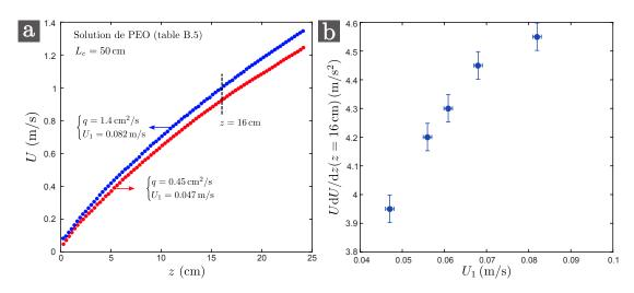
Figure 7.8 – (a): Profil de vitesse U(z) pour une solution de PEO extrudée à des débits  $q = 0.45 \text{ cm}^2/\text{s}$  et 1.4 cm<sup>2</sup>/s. La vitesse  $U_1$  à  $z_1 \approx 2.5 \text{ mm}$  de la fente est respectivement 0.047 m/s et 0.082 m/s. (b): Accélération locale UdU/dz à z = 16 cm de la fente en fonction de  $U_1$ . La longueur du rideau est  $L_c = 50$  cm.
