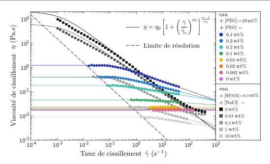
Figure 7.4 – Viscosité de cisaillement  $\eta(\dot{\gamma})$  pour des solutions de PEO dans un solvant à 20 wt% de PEG et pour des solutions de HPAM avec différentes concentrations en sel. Les données sont ajustées avec la loi de Carreau 7.9. La limite de résolution de l'appareil (couple minimum mesurable) est montrée.
