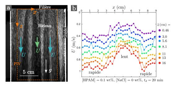
Figure 7.12 – Exemple de mesure de PIV sur une solution de HPAM non salée. (a): Superposition d'images successives. (b): Composante verticale du champ de vitesse, i.e. U(x, z, t), en fonction de la coordonnée horizontale x à différentes distances z de la sortie de la fente à un temps arbitraire t. La longueur du rideau est  $L_c = 30$  cm et le débit linéique est q = 3.1 cm<sup>2</sup>/s.
