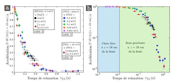
Figure 7.9 – Accélération UdU/dz adimensionnée par g, mesurée à z = 18 cm de la fente, en fonction du temps de relaxation extensionnel  $\tau_{fil}$  en échelles linéaires (a) et logarithmique (b) pour toutes les solutions utilisées (PEO et HPAM) et pour des rideaux de longueur  $L_c = 30$  cm.
