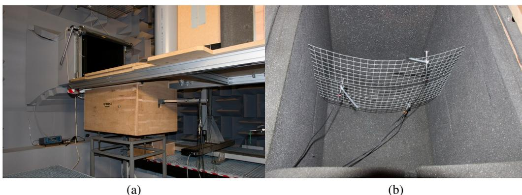
FIGURE 3.6 – Caisson anéchoïque dans la soufflerie BETI : (a) vue extérieure ; (b) vue intérieur.
