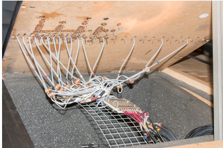
FIGURE 3.8 – Photographie des prises de pression sous la plaque instrumentée.
