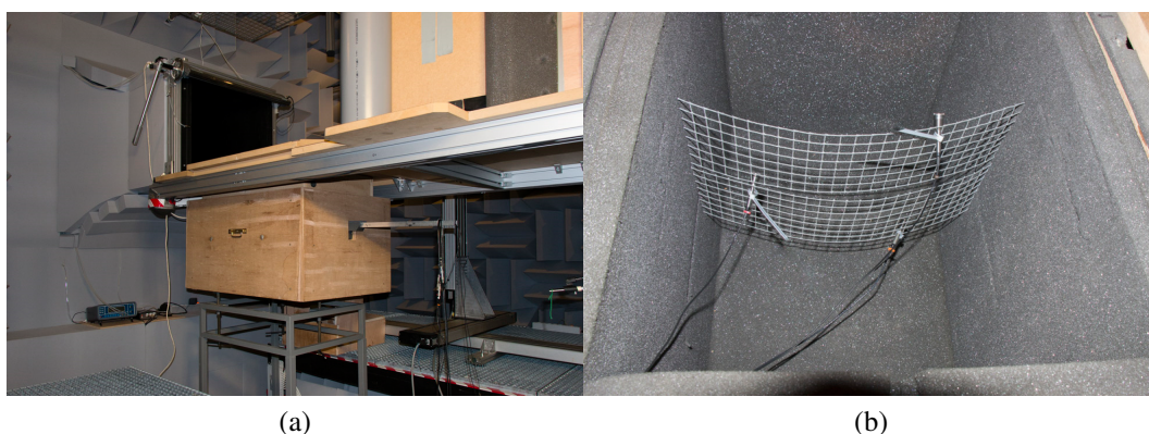
FIGURE 3.6 – Caisson anéchoïque dans la soufflerie BETI : (a) vue extérieure ; (b) vue intérieur.
