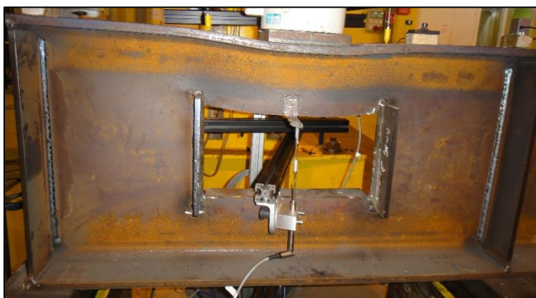
Figure A-14 : A2RHV3 - Illustration du mode de ruine
