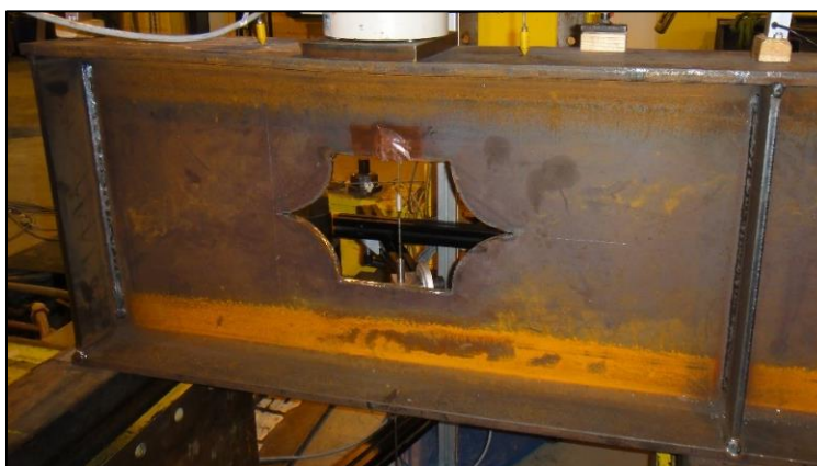
Figure A-34 : A2CIL3 - Illustration du mode de ruine
