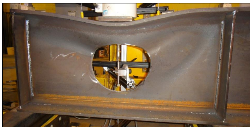
Figure A-24 : A3CEL3 - Illustration du mode de ruine
