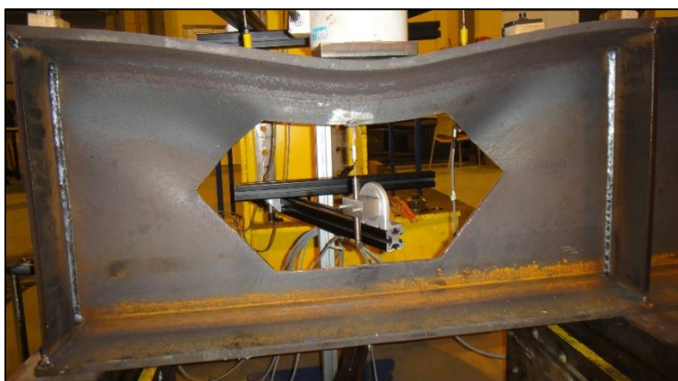
Figure A-18 : A3HEL5 - Illustration du mode de ruine
