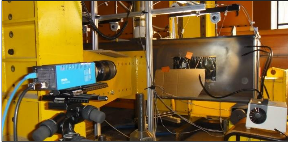
Figure II-68 : La caméra rapide 1200 hs PCO 1200 hs PCO
