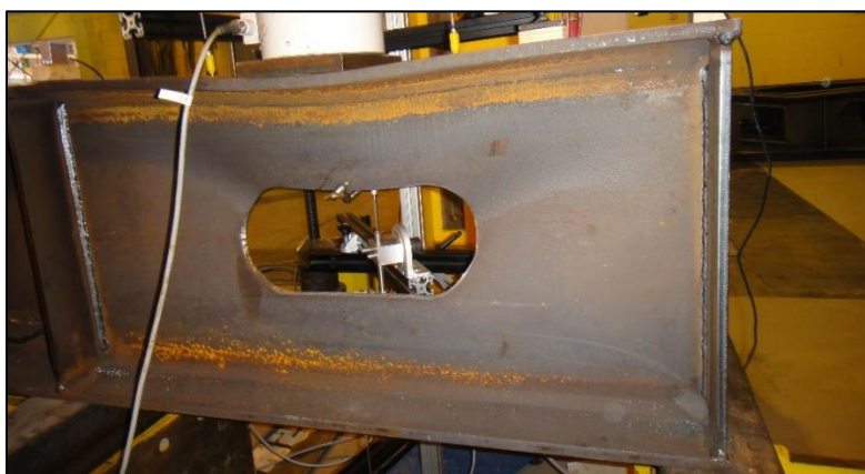
Figure A-30 : A2ACL3 - Illustration du mode de ruine
