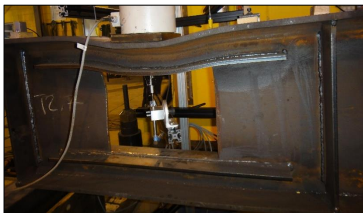
Figure A-2 : A3RHD7 - Illustration du mode de ruine
