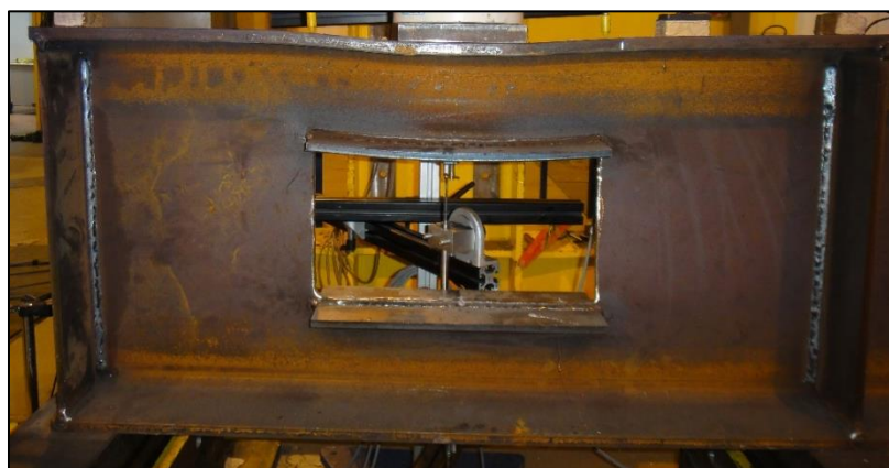
Figure A-10 : A2RHD3 - Illustration du mode de ruine
