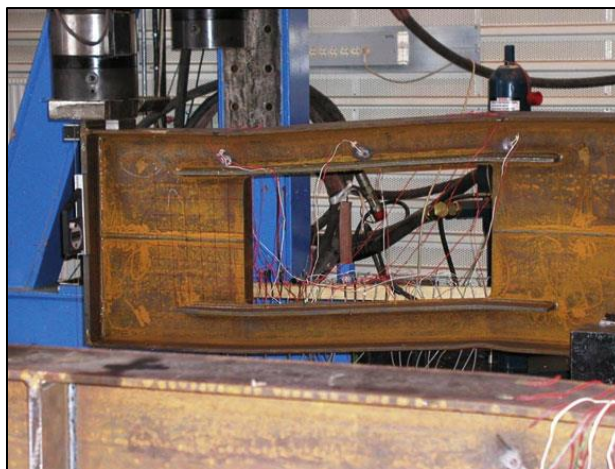
Figure I-36 : Tronçon de poutre avec ouverture d'âme et raidisseurs horizontaux testé en flexion
