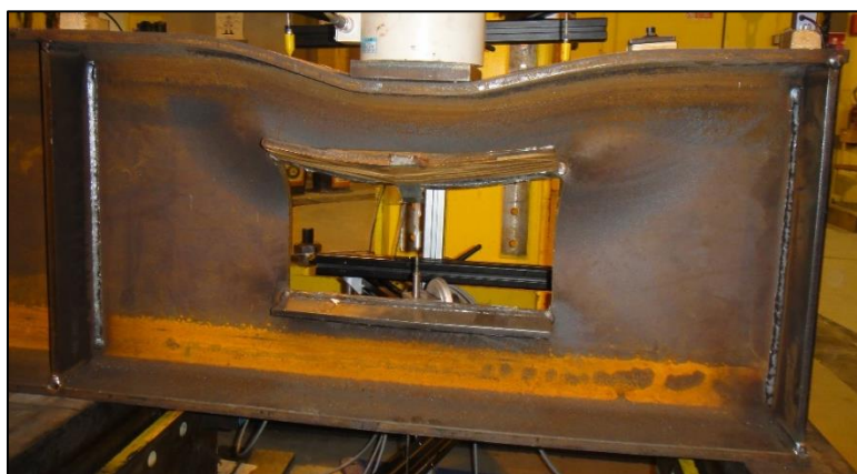
Figure A-6 : A2RHS3 - Illustration du mode de ruine
