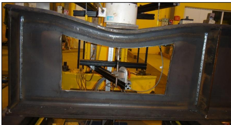
Figure A-20 : A3REL5 - Illustration du mode de ruine
