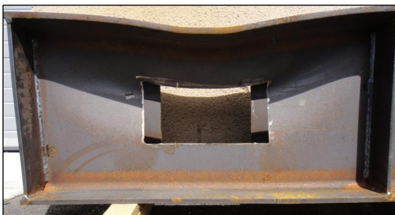
Figure A-26 : A2REL3 - Illustration du mode de ruine
