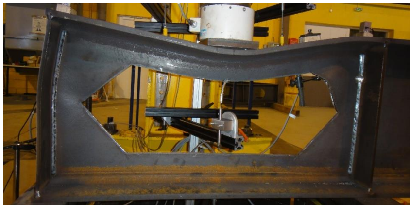
Figure A-22 : A3HEL8 - Illustration du mode de ruine
