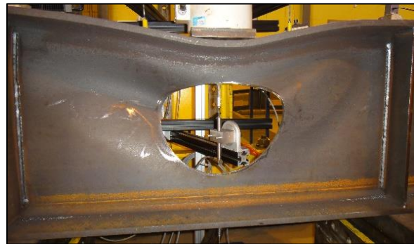
Figure III-11 : Exemple du mode de ruine par écrasement du panneau d'âme avec ouverture
