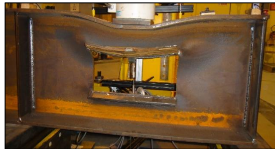
b- Mode de ruine de la poutre A2RHS3
