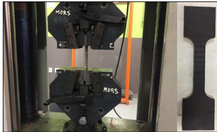
Figure II-8 : Photo du dispositif expérimental utilisé pour les essais de traction
