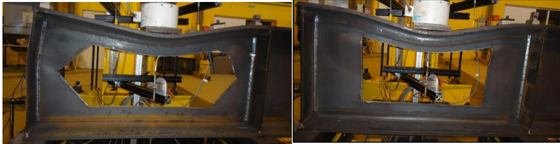
Figure III-18 : Déformée à la ruine pour les configurations A3HEL8 et A3REL5
