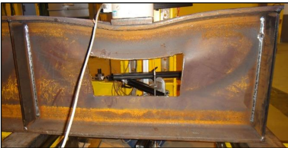
a- Mode de ruine de la poutre A2RHS0
