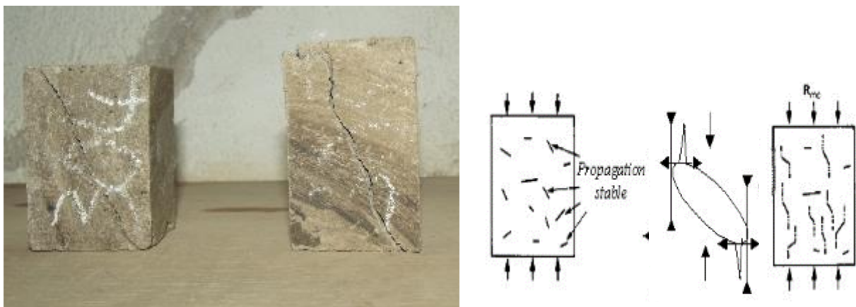
Figure 48: Image de la rupture en compression et schéma explicatif de la propagation des fissures.
