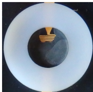
FIGURE 3.17 – Filament non totalement recouvert par la ZPP
