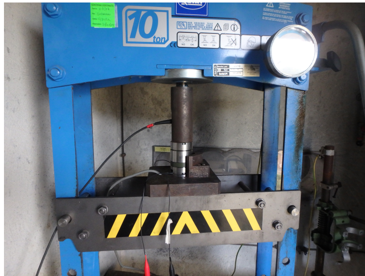
FIGURE 3.22 – Photo de la bombe manométrique pour impulseurs triples montée sur presse
