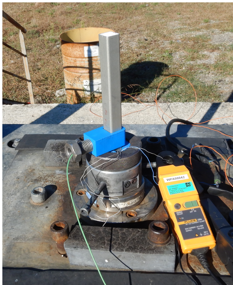
FIGURE 3.24 – Dispositif pour tir semi-dynamique d'impulseurs triples
