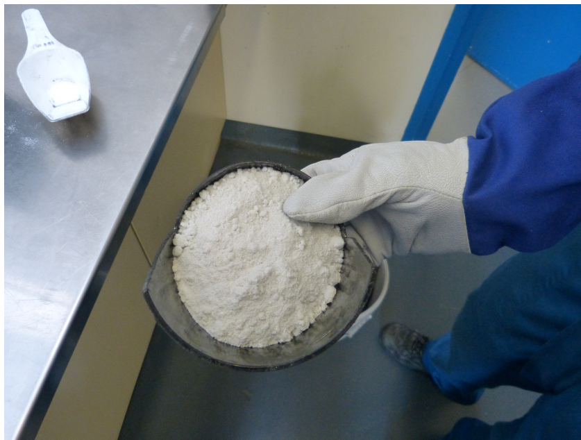
FIGURE 2.2 – Poudre pyrotechnique avant compression, ici inerte, le métal combustible ayant été remplacé par un oxyde métallique
