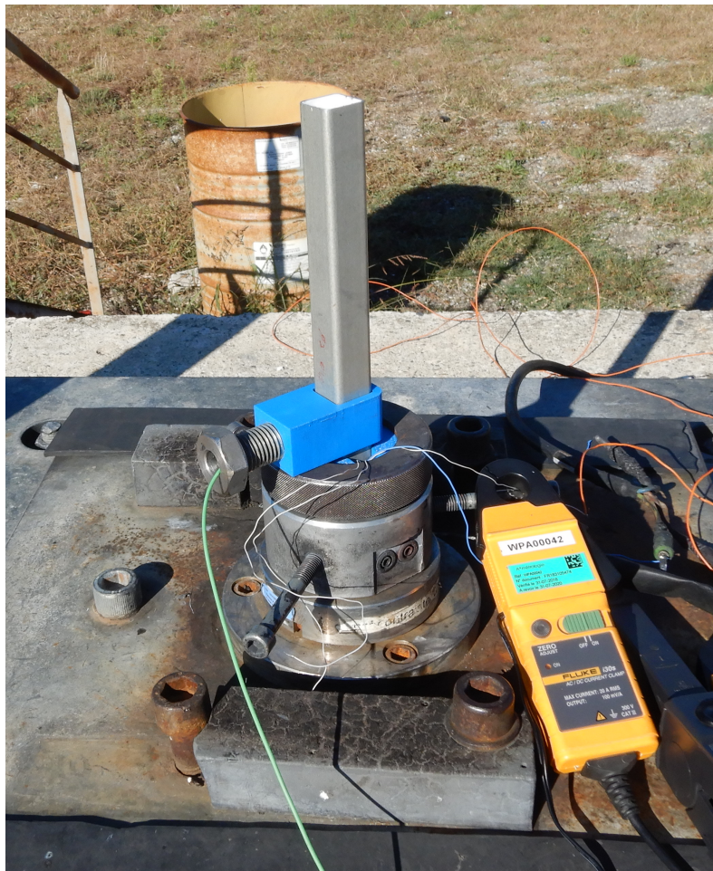
FIGURE 3.24 – Dispositif pour tir semi-dynamique d'impulseurs triples
