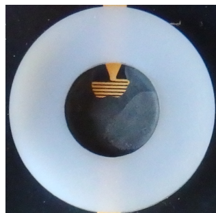
FIGURE 3.17 – Filament non totalement recouvert par la ZPP
