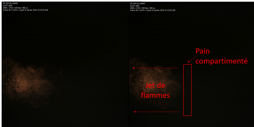
FIGURE 2.32 – Vidéo infrarouge - Solution compartimentée, un seul compartiment allumé
