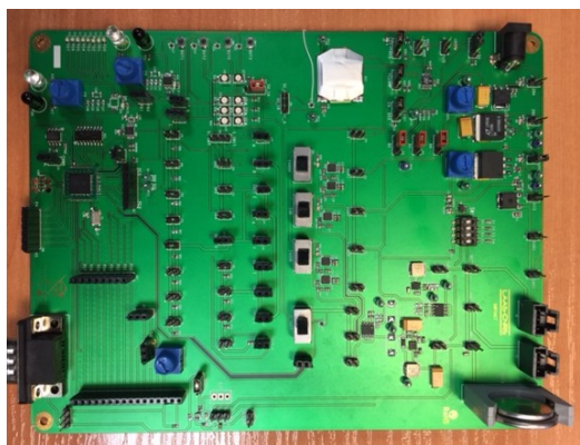
FIGURE 4.6 – Plate-forme de test électronique pour CASSIS
