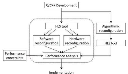
Figure 1 - Flot de conception de la reconfiguration définie logiciellement.
