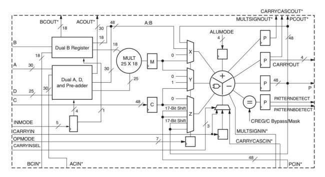
Figure 5.1 Virtex-6 FPGA DSP48E1 Slice [81]
