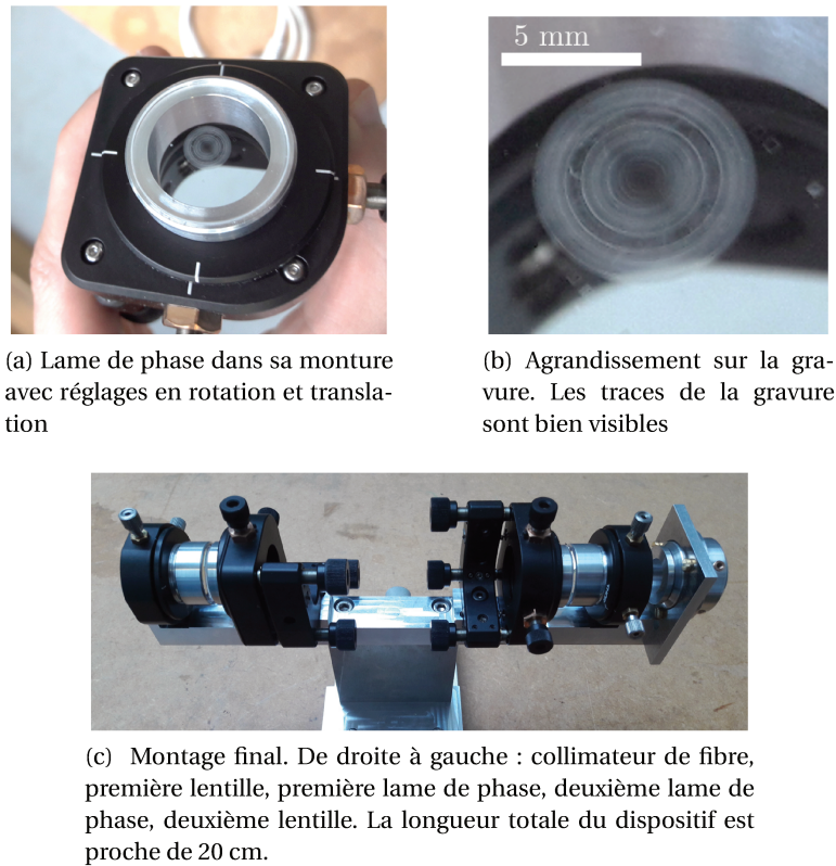
FIGURE 2.7 – beamshaper réalisé avec des masques de phase.
