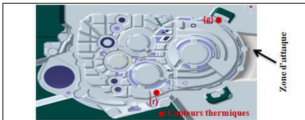
Figure 1. 7 : Emplacement des capteurs thermiques dans l'outillage
