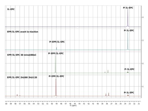
**Figure 6** Spectre <sup>31</sup>P NMR d'IL-EPC et du système EPP/IL-EPC avant la réaction et après 30 minutes et 5 heures de cuisson.
