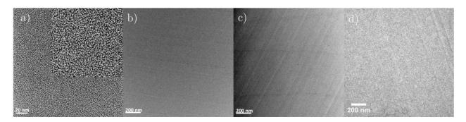
**Figure 3** Images MET des réseaux époxyde contenant IL-EPC (a), IL-TMP (b), IL-DEP (c) and IL-EHP (d).
