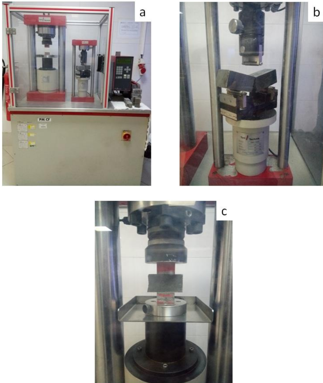
Figure II- 23: Machine utilisée pour les essais mécaniques sur le mortier a. vue de l'ensemble, b. dispositif employé pour l'essai de flexion c. dispositif employé pour l'essai de compression
