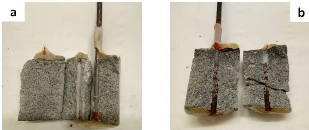
Figure III- 26: Photos relatives à l'observation de la surface d'acier enrobé de mortier précontraint témoin a. après le cycle C_3 et b. à la fin de l'essai (cycle C_7 )
