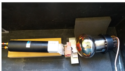
(a) À gauche un photomultiplicateur couplé avec un cube de scintillateur. Au centre, sur le support en cuivre, la source et à droite un scintillateur très fin couplé avec un photomultiplicateur de NEMO-3.
