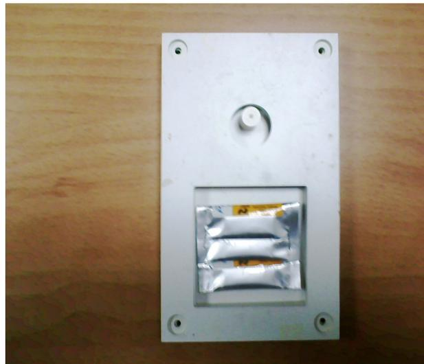
**Figure 6.10 :** Photo du fantôme d'irradiation  $\gamma$  du type Risø pour l'étalonnage sur site.
