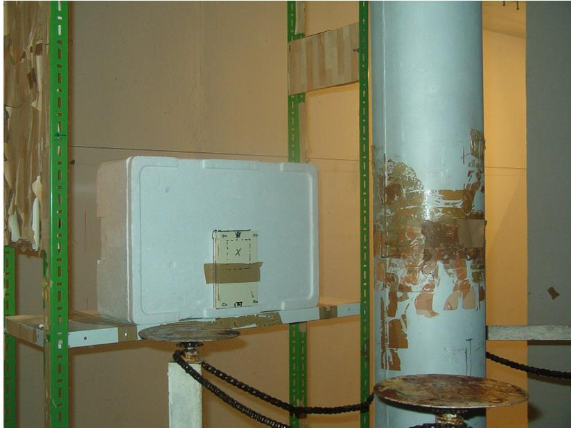
**Figure 6.11 :** L'arrangement d'irradiation pour l'étalonnage sur site du dosimètre de verre.
