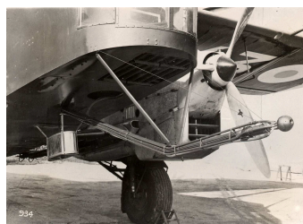
(b) Anémoclinomètre IMFL monté en avant du fuselage de l'avion laboratoire (Potez 54) de la Commission de turbulence atmosphérique [Archives de l'ONERA Lille].
