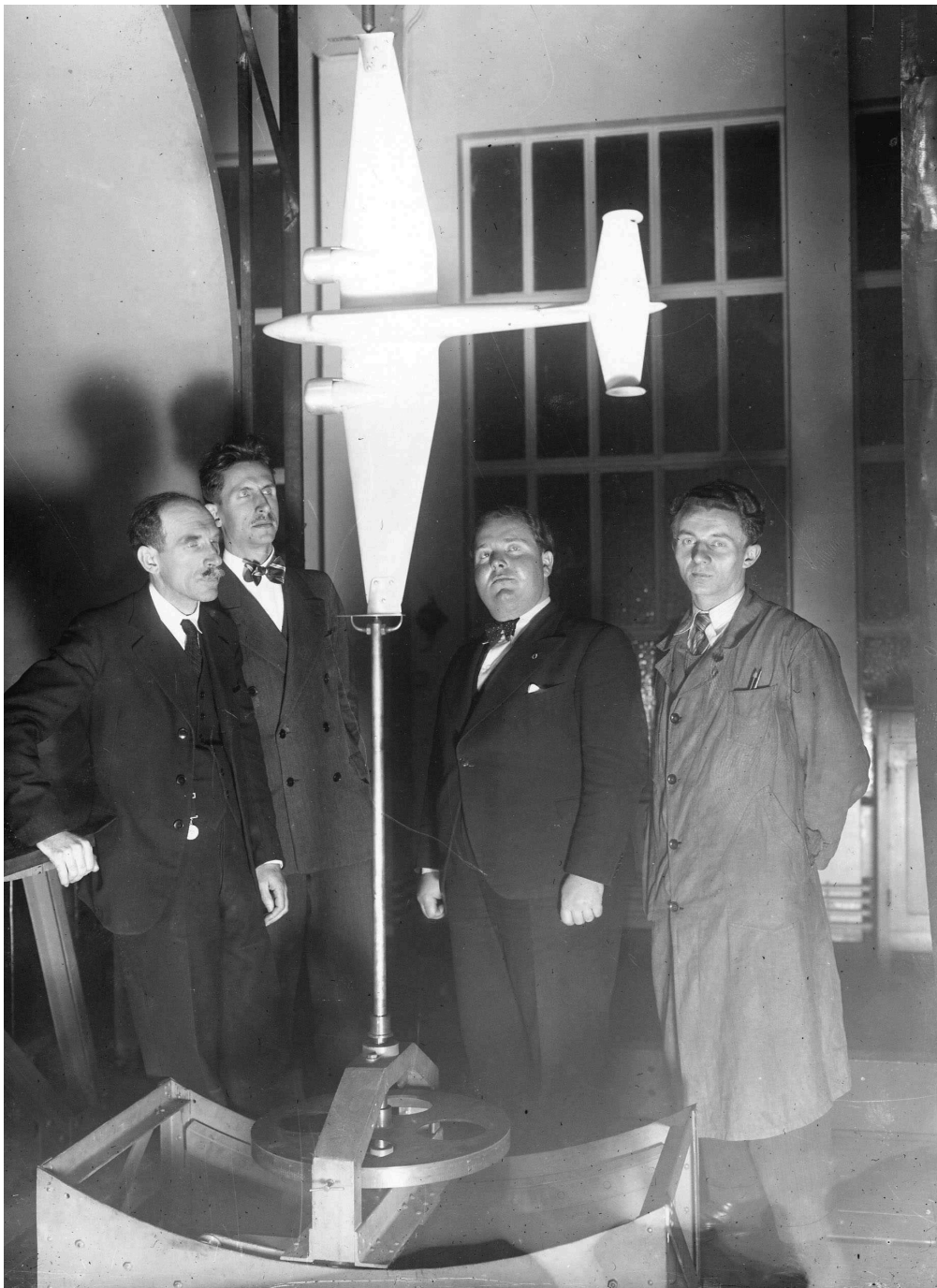
FIGURE 2.10 – IMFL : Visite de la soufflerie horizontale dans les années 1937-1938. Maquette d'un avion Potez, type P-63, attachée sur un montage dit de "girouette Lapresle". De gauche à droite : Kampé de Fériet, directeur de l'IMFL ; Martinot-Lagarde, son adjoint ; un ingénieur des Établissements Potez et Guienne, un responsable de la soufflerie [Archives de l'ONERA Lille].
