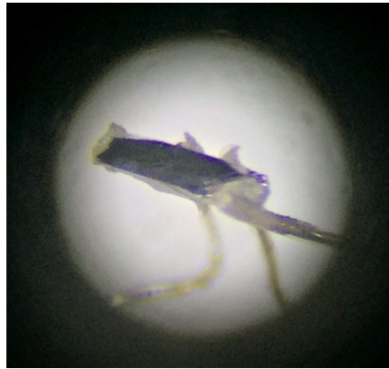
FIGURE 3.4 – Photographie d'un monocristal de \text{RuO}_2 contacté avec des fils d'argent de 25\mu\text{m} de diamètre. Les dimensions de cet échantillon, \sim 300 \times \sim 50 \times \sim 50\mu\text{m}^3 , sont représentatives de celles des monocristaux les plus gros. ©Florent Pawula
