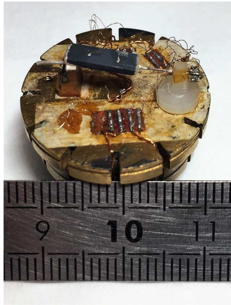
FIGURE 2.3 – Photographie du support à conduction de chaleur calibrée © Florent Pawula .
