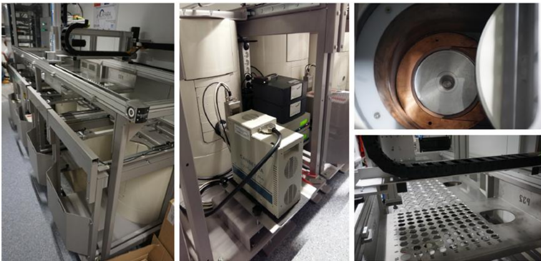
Figure 3.7 : Spectromètres gamma bas-bruit et leurs équipements (passeur automatique, cryogénérateur, château de plomb et magasins) installés au LAFARA
