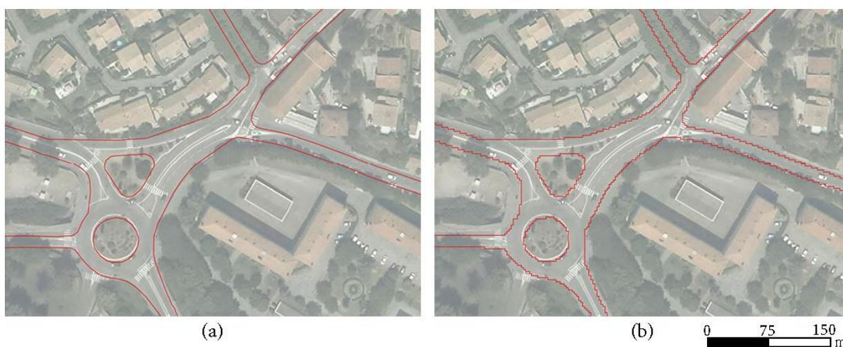
Figure 33. Extrait (a) d'un socle polygonal de référence des infrastructures linéaires issue de la BD TOPO® IGN, (b) modifié géométriquement lors du processus de SI
