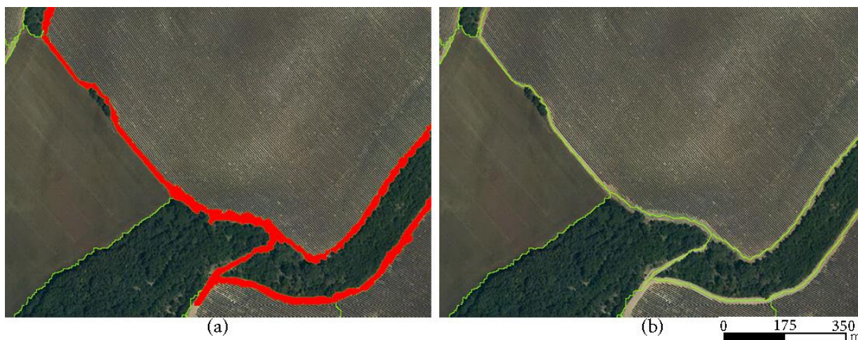
Figure 102. (a) Identification des objets « fins » (en rouge) issues de la segmentation à partir de la « largeur estimée » l_{est} ( \leq 15 m). (b) Opération morphologique (érosion) jusqu'à disparition totale de ces objets « fins »
