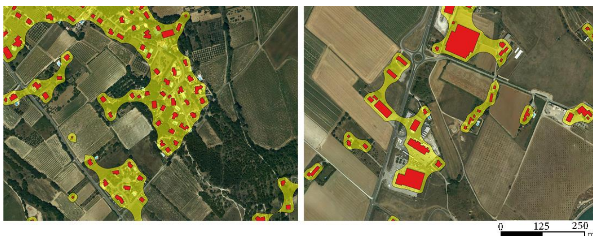
Figure 63. Délimitation approximative d'une « tache urbaine » (en jaune) réalisée par déformation morphologique (dilatation-érosion) à partir des bâtiments vectorisés de la BD TOPO® de l'IGN (en rouge)
