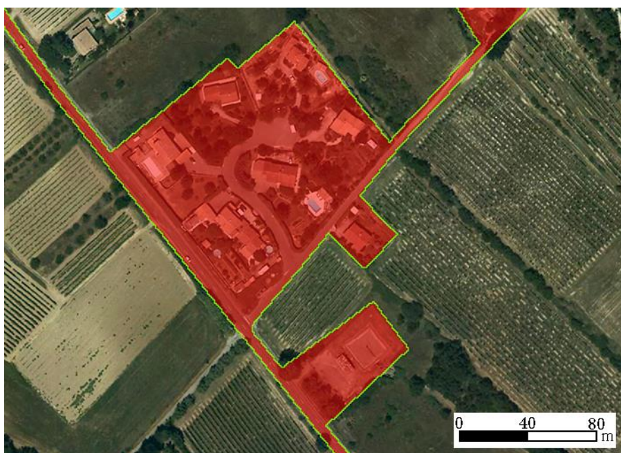
Figure 92. Intégration de « l'ossature polygonale » composée des espaces urbains et du réseau routier (en rouge) avant la procédure de segmentation. Délimitation « dentelée » (en vert) de l'ossature causée par la rasterisation d'eCognition®
