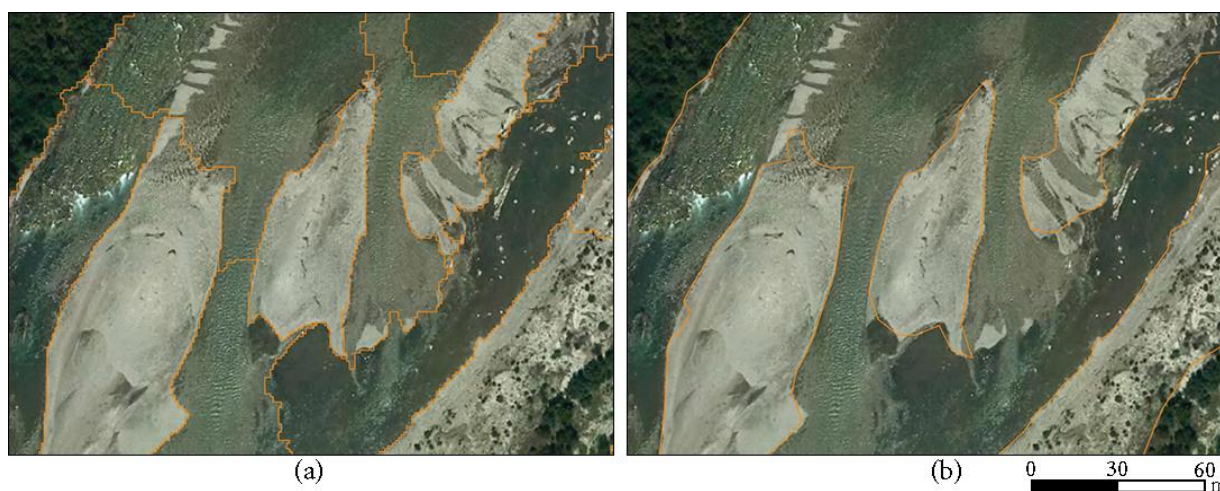
Figure 112. Exemple de délimitation des objets dans un procédé de segmentation (a) et lors d'une digitalisation manuelle (b)
