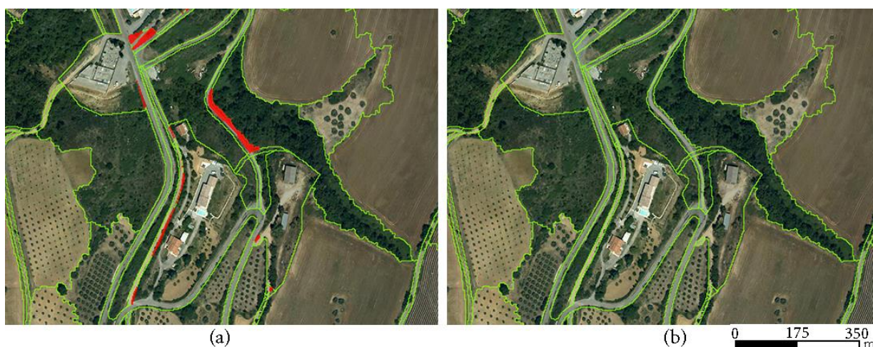
Figure 100. (a) Identification des objets « artefacts » (en rouge) issus de la segmentation selon un critère de superficie ( \leq 500 \text{ m}^2 ). (b) Agrégation de ces objets avec un objet voisin partageant le maximum de contact
