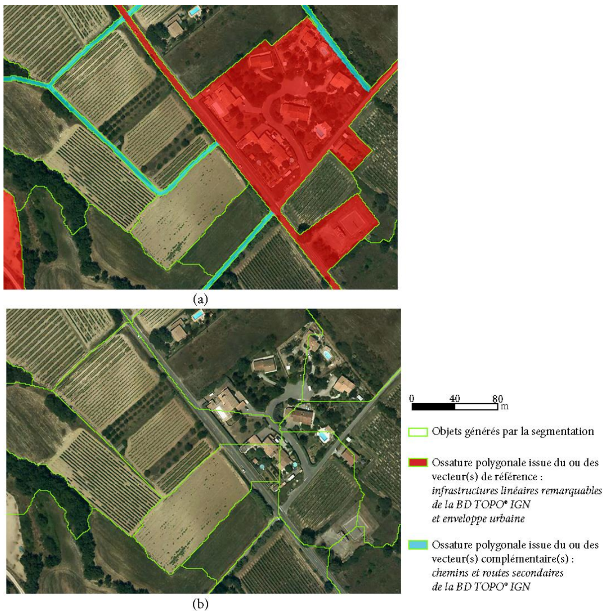
Figure 94. Post-traitement morphologique sur les ossatures polygonales de référence et complémentaires : (a) emprise spatiale des ossatures polygonales, (b) érosion morphologique des ossatures jusqu'à la disparition totale de celles-ci.
